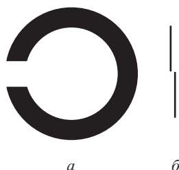
Рис. 14.11. Тест-объекты для исследования остроты зрения: а — кружок Ландольта, б — объект для испытания повышенной разрешающей силы глаза
