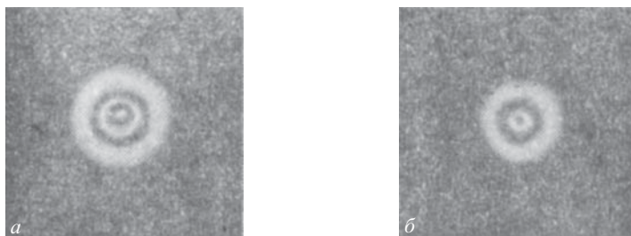
Рис. 8.12. Картины дифракции на круглом отверстии: a — отверстие открывает нечетное число зон, в центральной точке поля ( B на рис. 8.11) — свет; b — отверстие открывает четное число зон, в центральной точке поля — темнота
