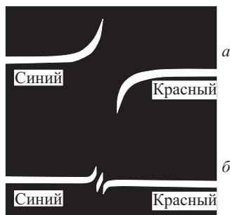
Рис. 28.5. Аномальная дисперсия в парах натрия: a — при значительной плотности пара обе линии поглощения натрия (дублет натрия) сливаются в полосу; b — при небольшой плотности пара обе линии дублета разделены
