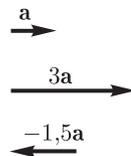
Рис. 42. Умножение вектора на число
