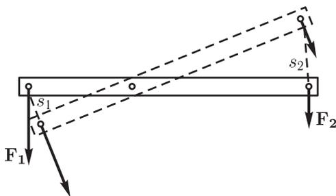
Рис. 155. Сила, действующая на левое плечо рычага, в  $n$  раз больше силы, действующей на правое плечо. Путь  $s_1$ , пройденный точкой приложения силы  $\mathbf{F}_1$ , будет в  $n$  раз меньше пути  $s_2$ , пройденного точкой приложения силы  $\mathbf{F}_2$
