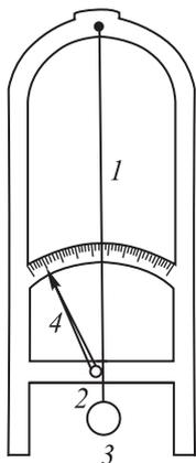
Рис. 503. Волосной гигрометр
