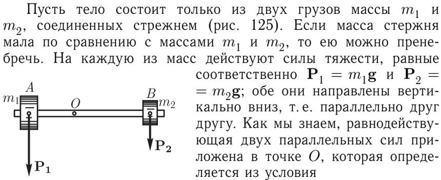
Рис. 125. Определение центра тяжести тела, состоящего из двух грузов
