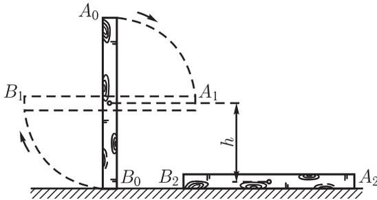
Рис. 164. При переходе столба из положения  $A_0B_0$  в положение  $A_1B_1$  сила тяжести не совершает работы, так как центр тяжести тела остается на месте. При переходе из положения  $A_1B_1$  в положение  $A_2B_2$  совершается работа  $mgh$
