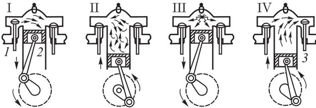
Рис. 524. Четыре такта работы двигателя внутреннего сгорания
