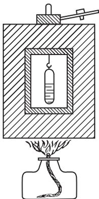
Рис. 498. Прибор для наблюдения критического состояния эфира
