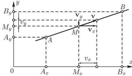
Рис. 46. Проектирование движения точки  $M$  на оси координат
