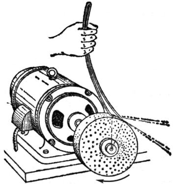
Рис. 48. Искры из-под предмета, обрабатываемого на токарном круге, летят по касательной к кругу
