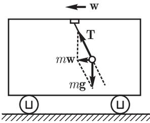
Рис. 205. Отклонение отвеса в ускоренно движущемся вагоне
