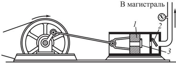
Рис. 302. Схема компрессора
