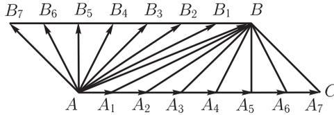
Рис. 44. Разложение вектора  $\vec{AB}$ , в котором задано только направление  $\vec{AC}$  одной составляющей. Вектор  $\vec{AB}$  может быть представлен как суммы векторов  $\vec{AA}_1$  и  $\vec{AB}_1$ ,  $\vec{AA}_2$  и  $\vec{AB}_2$ ,  $\vec{AA}_3$  и  $\vec{AB}_3$  и т. д.
