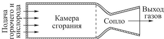
Рис. 333. Сопло реактивного двигателя
