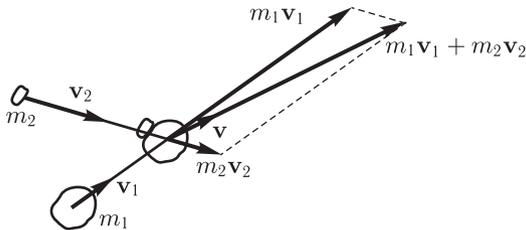
Рис. 74. Сложение импульсов при неупругом соударении двух тел
