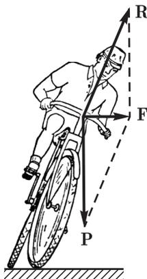
Рис. 194. Велосипедист наклоняется в сторону поворота. Сила тяжести  $\mathbf{P}$  и сила реакции  $\mathbf{R}$  со стороны земли дают равнодействующую силу  $\mathbf{F}$ , сообщаящую центростремительное ускорение, необходимое для движения по окружности
