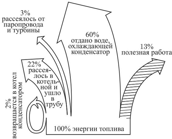
Рис. 519. Примерный энергетический баланс паросиловой станции с турбиной
