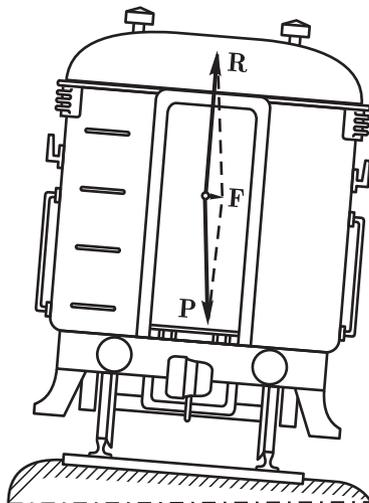
Рис. 195. Наклон железнодорожного пути на закруглении. Сила тяжести  $\mathbf{P}$ , действующая на вагон, и сила реакции  $\mathbf{R}$  рельсов дают результирующую силу  $\mathbf{F}$ , обуславливающую центростремительное ускорение вагона
