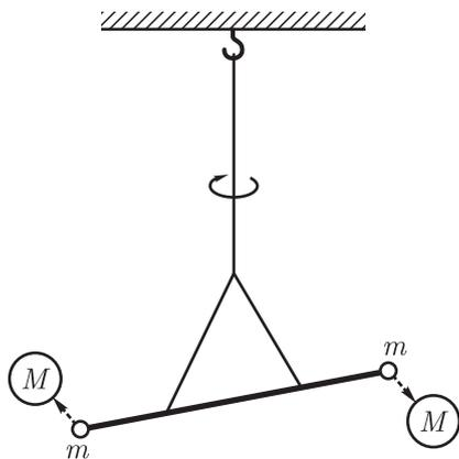
Рис. 202. Схема крутильных весов для измерения гравитационной постоянной
