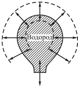
деле, рассмотрим подробнее, какие силы действуют на оболочку воздушного шара, наполненного, легким газом, например водородом. Нижнюю часть оболочки воздушного шара оставляют открытой (рис. 300); давление водорода у нижнего
