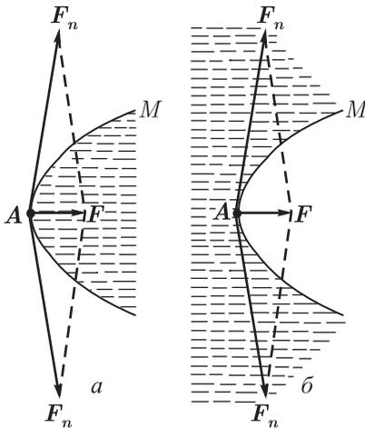
Рис. 417. Силы поверхностного натяжения  $F_n$ , действующие на искривленную поверхность жидкости, дают результирующую  $F$ , направленную в ту же сторону, куда поверхность  $M$  обращена своей вогнутостью.  $a$ ) Поверхность жидкости выпуклая.  $b$ ) Поверхность жидкости вогнутая
