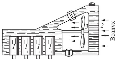
Рис. 525. Схема устройства водяного охлаждения цилиндров двигателя автомобиля
