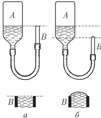
Рис. 418.  $a$ ) Поверхности воды в трубках  $A$  и  $B$  находятся на одном уровне; обе поверхности плоские.  $b$ ) Поверхность воды в  $A$  выше, чем в  $B$ ; поверхность в  $A$  — плоская, в  $B$  — выпуклая
