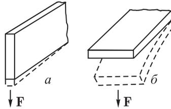
Рис. 472. Зависимость прогиба от формы сечения балки
