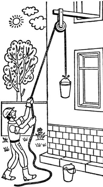
Рис. 141. Применение простого блока для подъема груза
