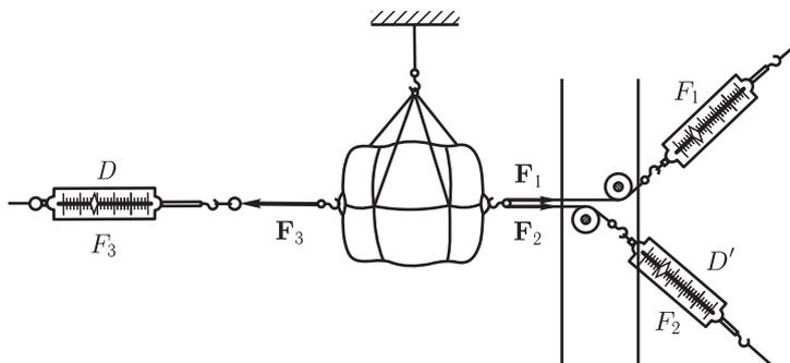
Рис. 63. Показание динамометра  $D$  дает модуль равнодействующей сил  $\mathbf{F}_1$  и  $\mathbf{F}_2$ . Показание динамометра  $D'$  дает модуль равнодействующей сил  $\mathbf{F}_1$  и  $\mathbf{F}_3$
