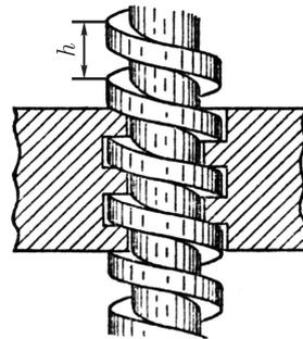
Рис. 151. Винт с гайкой ( $h$  — шаг винта)
