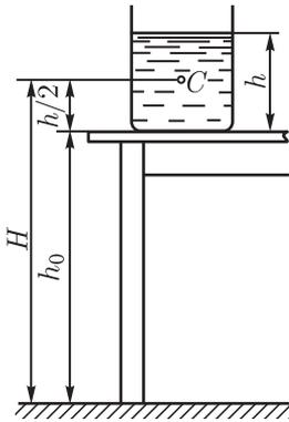
Рис. 165. К расчету потенциальной энергии жидкости в сосуде
