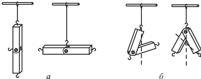
Рис. 129. а) Центр тяжести соединенных шарниром брусков, расположенных на одной прямой, лежит на оси брусков. б) Центр тяжести согнутой системы брусков лежит вне брусков
