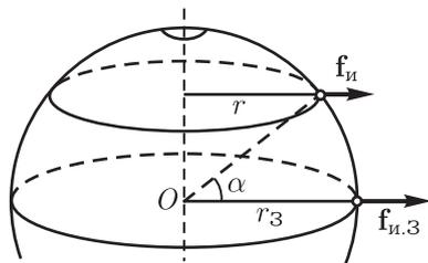
Рис. 208. Центробежная сила инерции на разных широтах
