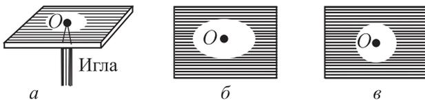
Рис. 442. а) При прикосновении раскаленной иглы к точке  $O$  тонкой пластинки на противоположной стороне плавится парафин. б) Пластика — кристалл гипса; площадь, на которой расплавился парафин, имеет форму эллипса. в) Пластика стеклянная; площадь имеет форму круга
