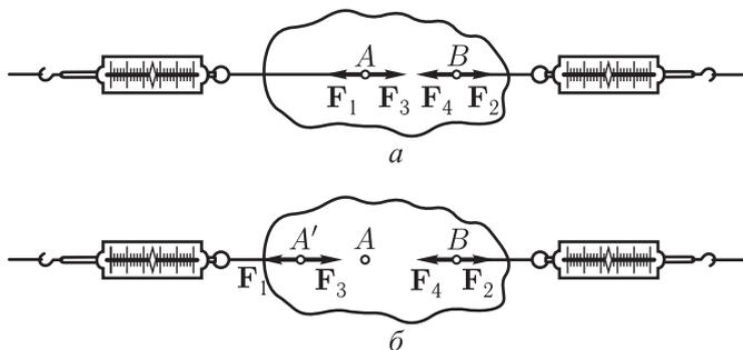
Рис. 96. а) В точках  $A$  и  $B$  к телу приложены равные по модулю силы  $\mathbf{F}_1$  и  $\mathbf{F}_2$  противоположного направления; в теле возникает деформация и появляются упругие силы  $\mathbf{F}_3$  и  $\mathbf{F}_4$ . б) При перенесении силы  $\mathbf{F}_1$  из точки  $A$  в точку  $A'$  равновесие не нарушается
