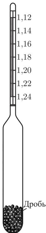
Рис. 266. Ареометр (шкала в  $10^3 \text{ кг/м}^3$ )
