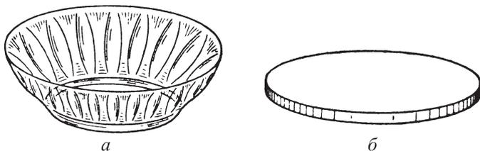
Рис. 454. а) Блюдец из плексигласа. б) То же блюдец после пребывания в кипящей воде
