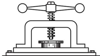
Рис. 154. Винтовой пресс
