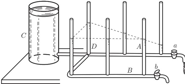
Рис. 310. Прибор для демонстрации падения давления в водопроводе
