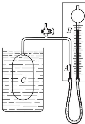
Рис. 386. Газовый термометр
