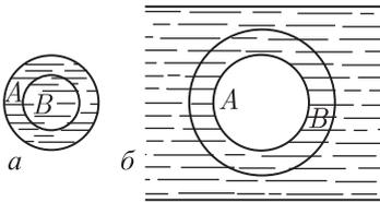
Рис. 493. *а)* Если капля *A* частично испарится, то ее новая поверхность *B* меньше начальной. *б)* Если жидкость частично испарится внутри пузыря *A*, то поверхность нового пузыря *B* больше начальной
