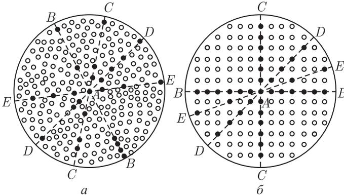
Рис. 446. а) Беспорядочное расположение частиц в жидкости. Любая прямая ( $BB$ ,  $CC$ ,  $DD$ , ...), проведенная через молекулу  $A$ , встречает одинаковое число частиц (они отмечены черными кружками). б) Упорядоченное расположение атомов в кристалле. Различные прямые ( $BB$ ,  $CC$ ,  $DD$ , ...), проведенные через молекулу  $A$ , встречают различное число атомов
