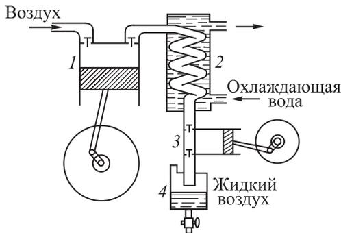
Рис. 500. Схема машины для получения жидкого воздуха
