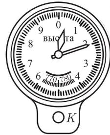
Рис. 295. Самолетный альтиметр. Длинная стрелка отсчитывает сотни метров, короткая — километры. Головка *K* позволяет подвести нуль циферблата под стрелку на поверхности Земли перед началом полета
