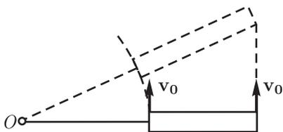
Рис. 188. Возникновение деформации в теле, движущемся по окружности
