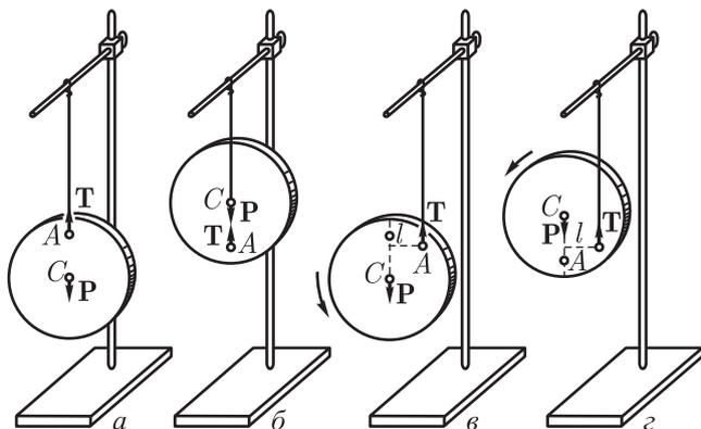
Рис. 132. *а*) Положение равновесия при центре тяжести  $C$ , расположенном ниже точки подвеса  $A$ . *б*) Положение равновесия при центре тяжести  $C$ , расположенном выше точки подвеса  $A$ . *в*) При отклонении тела из положения *а*) сила тяжести создает момент, возвращающий тело в положение равновесия. *г*) При отклонении тела из положения *б*) сила тяжести создает момент, удаляющий тело от положения равновесия
