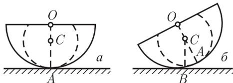
Рис. 133. Так как в положении  $a$ ) центр тяжести расположен ниже, чем в положении  $b$ ), то равновесие устойчиво
