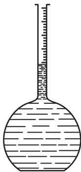
Рис. 364. Прибор для измерения коэффициента объемного расширения жидкости
