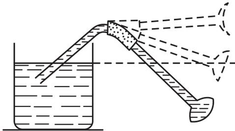
Рис. 246. Выгибание резиновой пленки при разных положениях трубки жидкости в сосуде) к плоской (конец трубки — на уровне жидкости) и ко все более выпуклой при дальнейшем опускании трубки.
