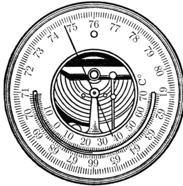
Рис. 294. Барометр-анероид
