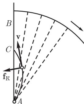
Рис. 209. Кусок мела, равномерно движущийся вдоль неподвижной линейки  $AB$ , описывает на доске, вращающейся в направлении стрелки, криволинейную траекторию  $AC$ :  $\mathbf{v}$  — скорость тела относительно вращающейся доски
