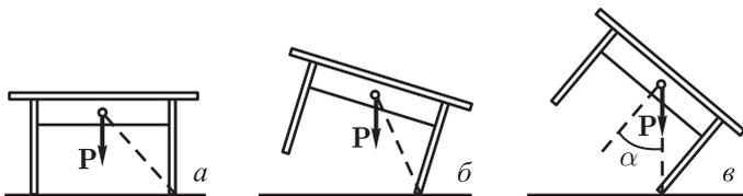
Рис. 134. При отклонении стола ( $b$ ) от его положения равновесия ( $a$ ) центр тяжести поднимается — равновесие устойчиво. В положении  $в$ ) стол отклонен на предельный угол; при дальнейшем отклонении центр тяжести будет опускаться — равновесие неустойчиво
