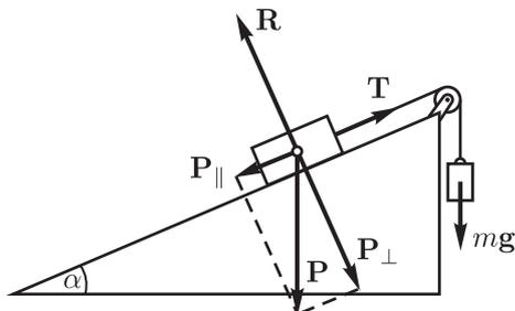
Рис. 108. Нахождение условий равновесия тела на наклонной плоскости
