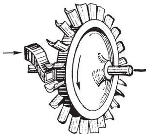
Рис. 516. Лопатки на рабочем колесе паровой турбины
