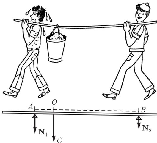
Рис. 124. Разложение силы на две параллельные составляющие
