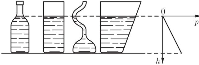
Рис. 233. График давления одинаков для сосудов различной формы
