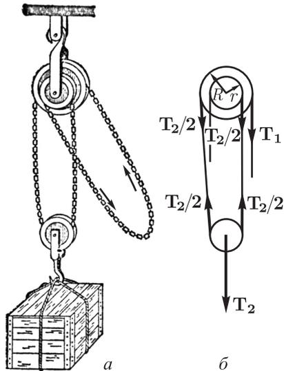
Рис. 146. а) Дифференциальный блок. б) Схема дифференциального блока
