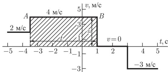
Рис. 24. Движение тела с разной скоростью в различные промежутки времени. Площадь заштрихованного на графике прямоугольника равна  $(4 \text{ м/с}) \cdot 4,5 \text{ с} = 18 \text{ м}$  (пройденный путь)
