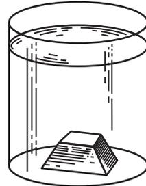
Рис. 271. Кусок парафина, лежащий на дне наположенного водой сосуда, не всплывает
