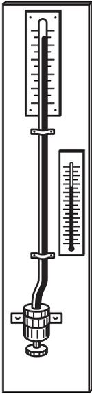
Рис. 291. Ртутный барометр
