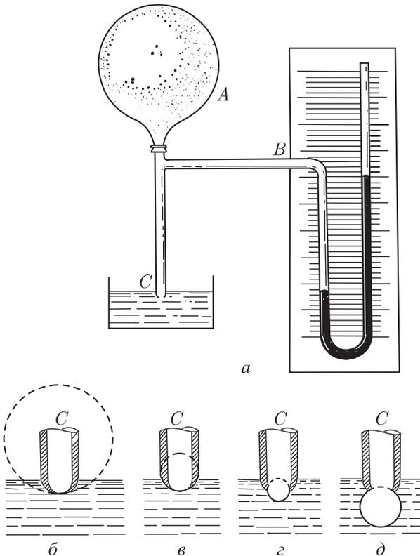
Рис. 419. *a*) Прибор для выдувания пузырьков в жидкости. *б*)–*г*) В начале выдувания пузырька радиус кривой поверхности жидкости постепенно уменьшается. *д*) Под конец выдувания радиус поверхности снова увеличивается
