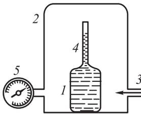
Рис. 215. Схема пьезометра
