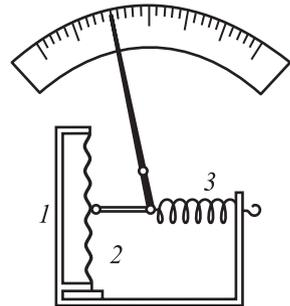
Рис. 293. Схема устройства мембранного манометра для газов
