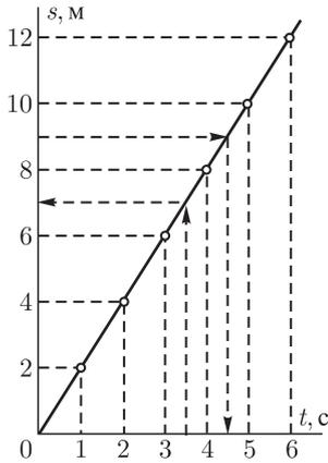
Рис. 18. График пути равномерного движения со скоростью 2 м/с
