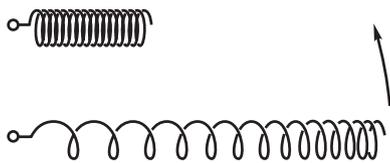
Рис. 189. Наглядное представление деформации вращающегося тела на примере пружины. Для сравнения вверху показана нерастянутая пружина
