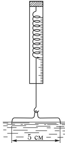
Рис. 406. Простой прибор для определения поверхностного натяжения жидкостей
