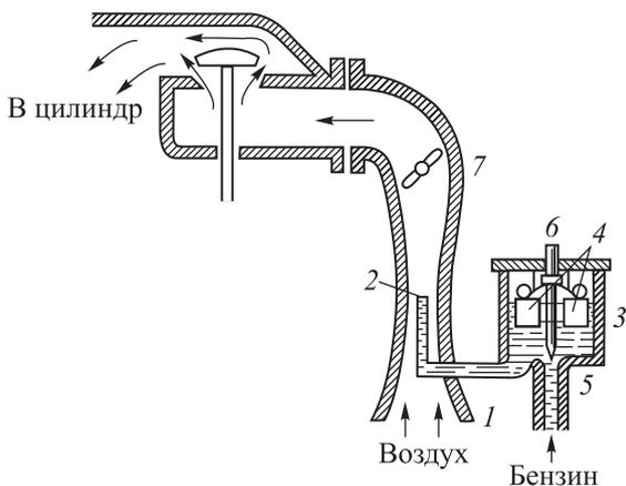
Рис. 523. Устройство карбюратора
