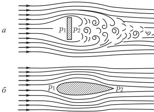
Рис. 335. а) Позади пластинки, помещенной в потоке, образуются вихри; давление  $p_2$  значительно меньше давления  $p_1$ . б) «Обтекаемое» тело плавно обтекается потоком; давление  $p_2$  лишь немного меньше давления  $p_1$
