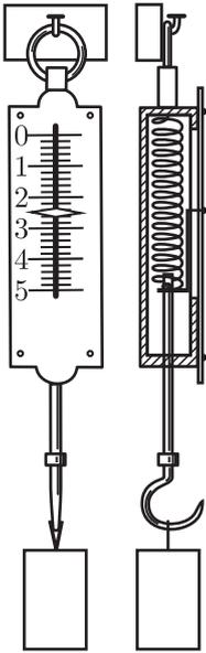
Рис. 59. Динамометр: слева — внешний вид, справа — внутреннее устройство
