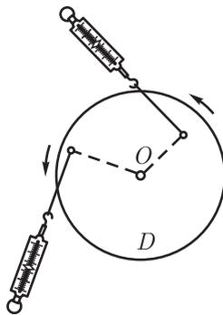
Рис. 114. При таком расположении динамометров равновесие невозможно
