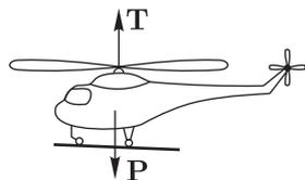
Рис. 350. Схема вертолета
