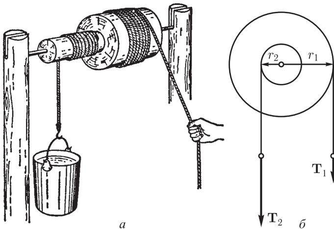
Рис. 143. а) Двойной блок. б) Схема двойного блока
