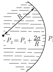
Рис. 420. Две среды граничат по сферической поверхности радиуса  $R$ , обращенной вогнутостью влево. При равновесии давление среды слева от границы больше, чем давление среды справа от границы, на величину  $2\sigma/R$
