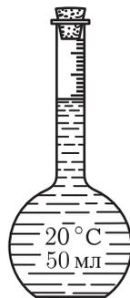
Рис. 363. Пикнометр
