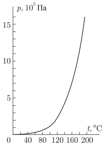
Рис. 481. Зависимость давления насыщенного пара воды от температуры
