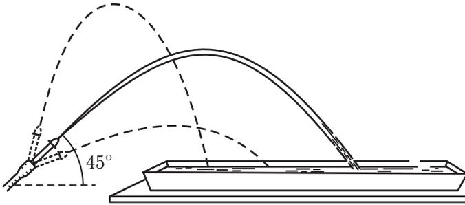
Рис. 180. При увеличении наклона струи, вытекающей с данной скоростью, расстояние, на которое она бьет, сначала увеличивается, достигает наибольшего значения при наклоне в  $45^\circ$ , а затем уменьшается
