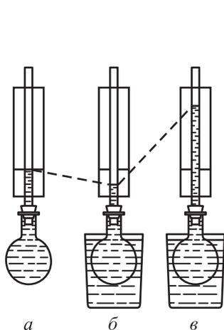
Рис. 357. *а*) Подкрашенная вода вошла из колбы в пробку. *б*) К колбе снизу подносится сосуд с горячей водой. В первый момент погружения колбы жидкость в трубке опускается. *в*) Уровень в трубке через некоторое время устанавливается выше, чем до нагревания колбы
