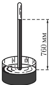
Рис. 290. Трубка Торричелли
