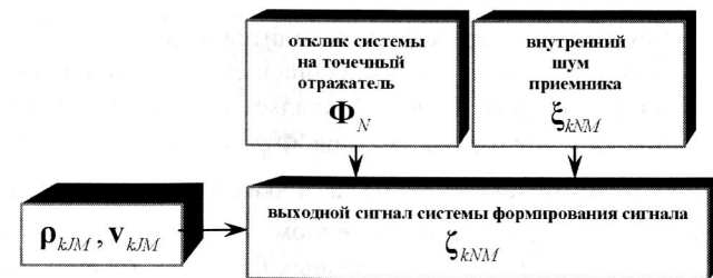
Рис. 3.13. Схема блока системы формирования сигнала в k -м антенном канале
