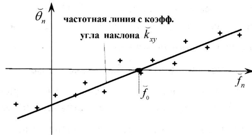
Рис. 9.9. Иллюстрация метода линейной аппроксимации зависимости измеренных значений углов прихода сигналов от их частоты
