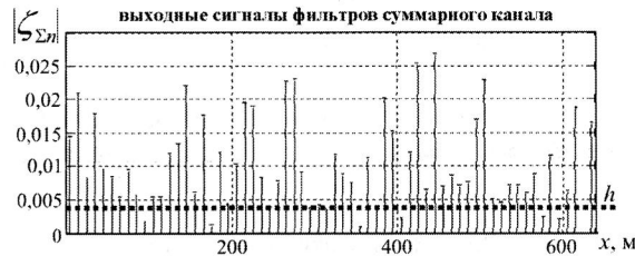
Рис. 6.7. Иллюстрация принципа пороговой селекции
