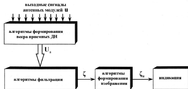
Рис. 8.4. Схема алгоритмов процессора обработки сигналов ГРЛС
