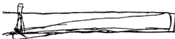
Рис. 22. Система телескопа Ньютона, видоизмененного М. В. Ломоносовым применением наклонного зеркала («Новое изобретение. Поправление ньютоновской трубки по моему»).
