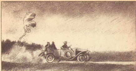
Испытание прочности парашюта «РК-1» с помощью автомобиля. Парашют выброшен из ранца. (По фотографии В. А. Ломача.)
