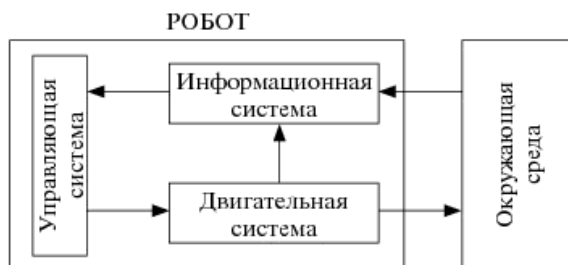
Рис. 1.1. Обобщенная структурная схема робота
