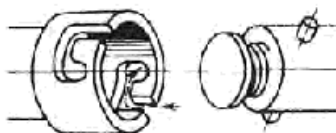
Рис. 9.13. Схема удержания ЗУ в руке ПР с использованием пружин
