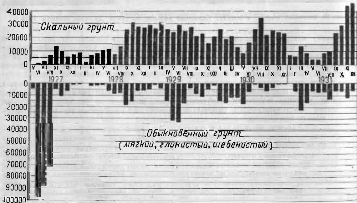
Рис. 72. Месячный график земельно-скальных работ на всех основных сооружениях за период от начала работ до конца 1931 г.
