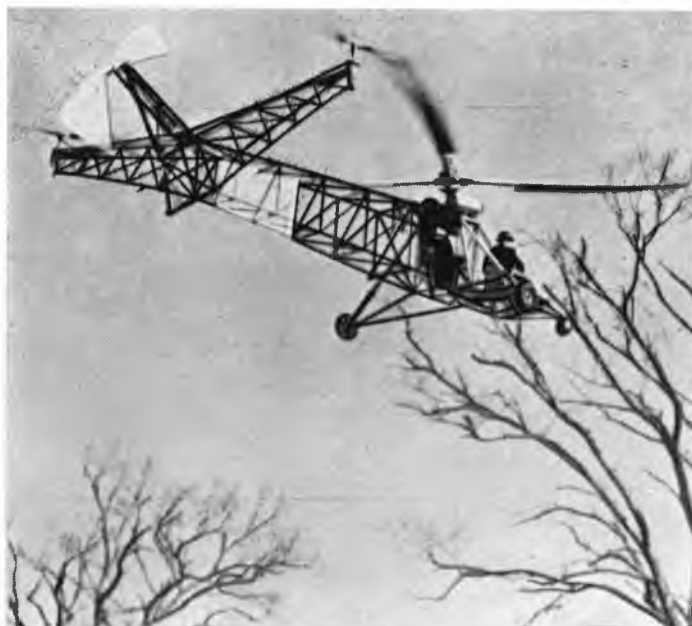
VS-300, модификация с тремя рулевыми винтами. 1940 г.
