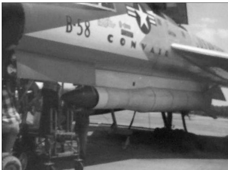
Рис. 22. Баллистическая ракета «Хай Вирго» на бомбардировщике В-58А
