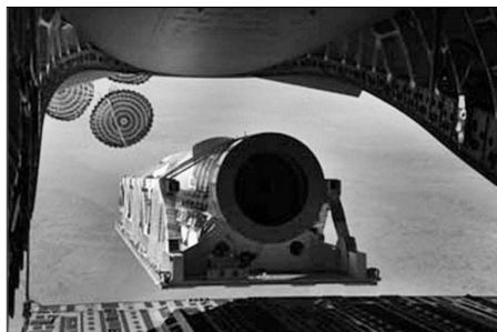
Рис. 59. Десантирование ракеты-мишени EMRBM с самолета C-17A
