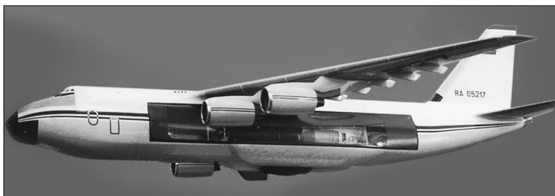
Рис. 71. Размещение баллистической ракеты типа Р-29Р на самолете Ан-124
