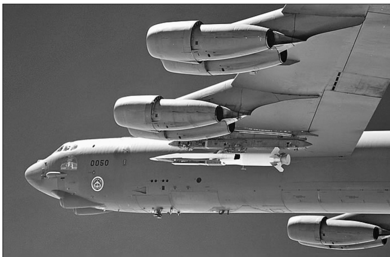
Рис. 114. Гиперзвуковая крылатая ракета X-51A на бомбардировщике B-52
