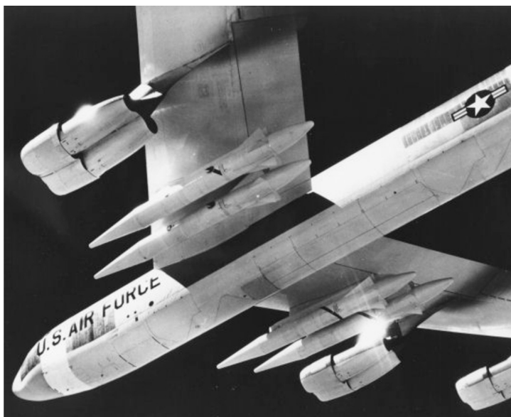
Рис. 26. Ракета «Скайболт» на бомбардировщике В-52
