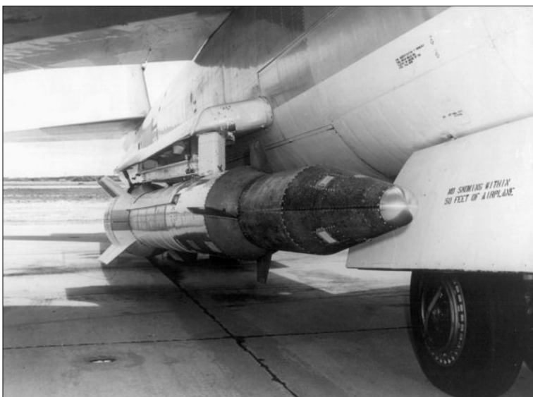
Рис. 19. Ракета «Болд Орион» на бомбардировщике В-47
