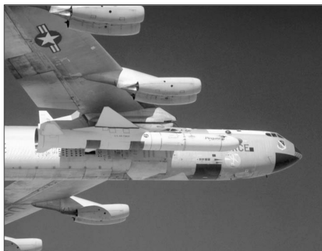
Рис. 60. Ракета «Пегас» на бомбардировщике B-52
