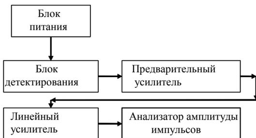
*Рис. 4.1. Структурная схема спектрометра*
