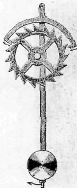
Рис. 192.—Маятникъ съ якоремъ и спусковымъ колесомъ.
