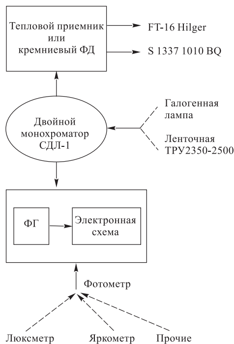
Рис. 6.3. Алгоритм определения относительной спектральной характеристики эталонных и прецизионных ФГ и фотометров
