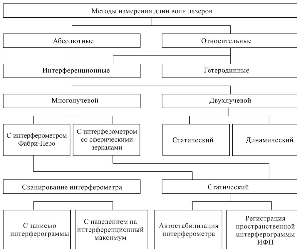
Рис. 19.1. Классификация методов измерения длин волн лазера
