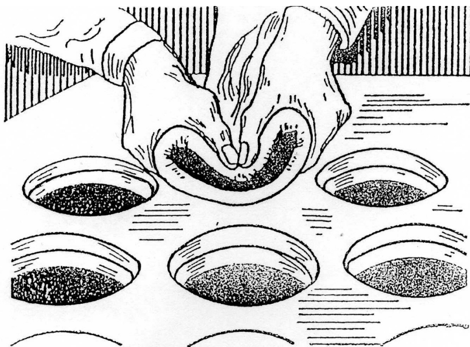
Рис. 7.6. Установка рукава с пружинящим кольцом в распределительной решётке.
