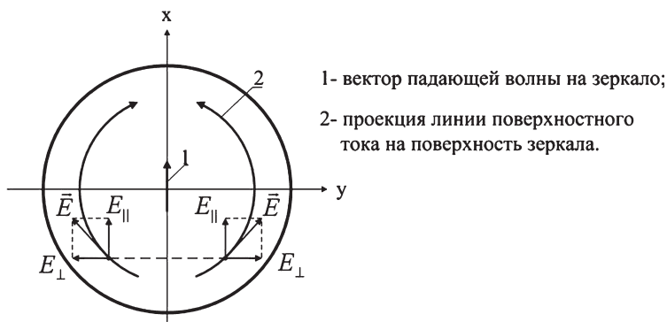
Рис. 10.17 Явление кроссполяризации в зеркальных антеннах
