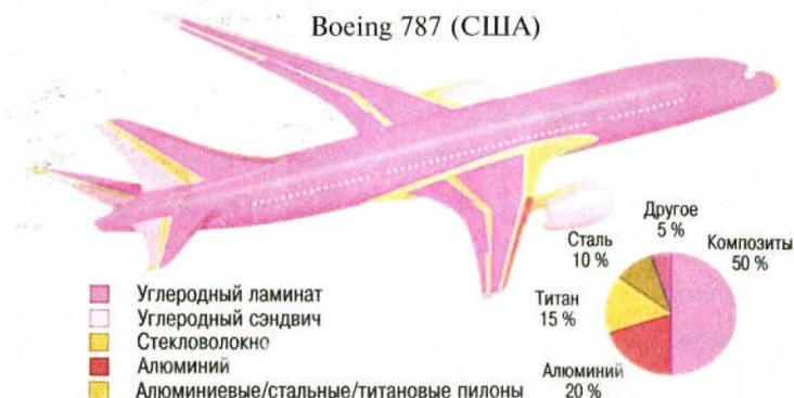
Рис. 2.4. Применение композиционных материалов в самолетах различных производителей
