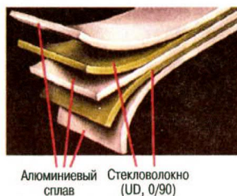
Рис. 2.3. Композиционный материал GLARE — алюминий, упрочненный стеклопластиком
