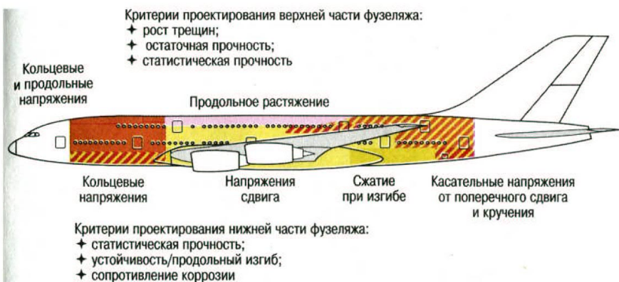
Рис. 2.1. Критерии проектирования фюзеляжа самолета Airbus A380
