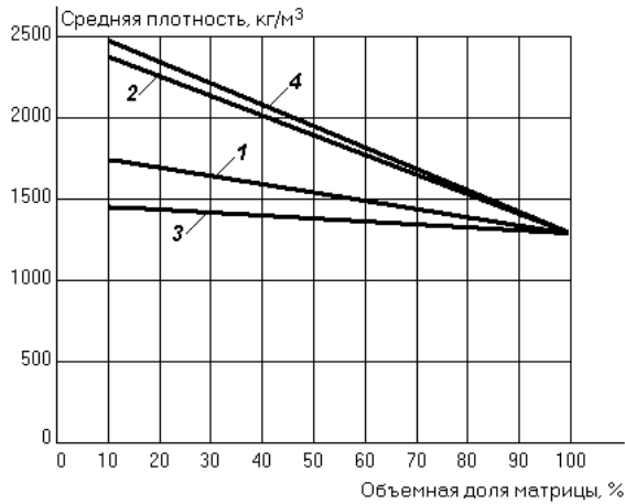
Рис. 1.5. Средняя плотность двухкомпонентных композитов: 1 — углепластик; 2 — стеклопластик; 3 — органопластик; 4 — боропластик
