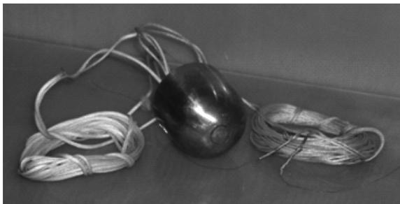
Рис. 10.2. Калориметрический датчик теплового потока
