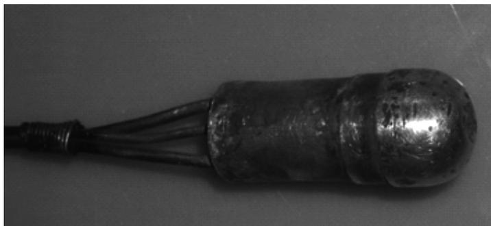
Рис. 10.3. Трубка полного напора
