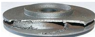
Рис. 8.5 Повреждения, наносимые эффектом кавитации (часть насоса)
