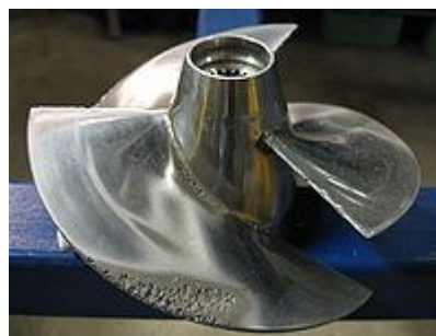
Рис. 8.6. Кавитационные повреждения гребного винта
