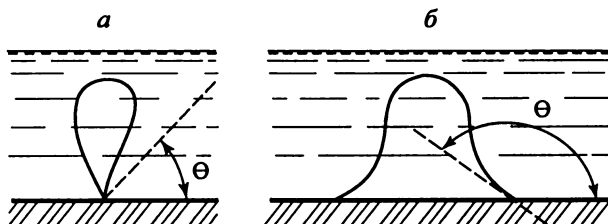
Рис. 10.15. Образование парового пузырька у смачивающих (а) и несмачивающих (б) жидкостей
