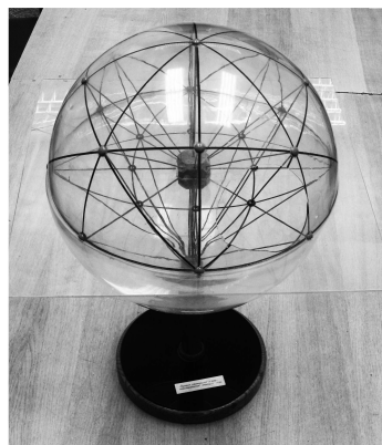
Рис. 14. а) Иллюстрация взаимосвязи положения точек A и D на сфере проекций и их стереографических образов a и d на экваториальной плоскости; б) модель для изучения основ стереографического проецирования
