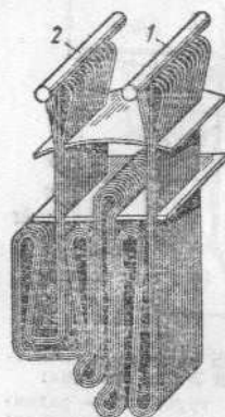
Рис. 135. Вертикальный пароперегреватель: 1 — распределительный коллектор; 2 — собирательный коллектор
