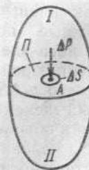
Рис. 4. К доказательству независимости величины гидростатического давления от ориентации площадки, на которую оно действует
