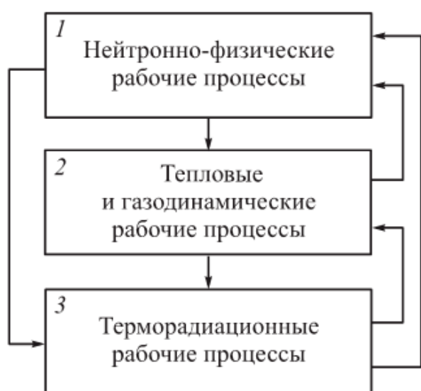
Рис. 4.1. Структура и взаимосвязи совокупного рабочего процесса теплового РД с ядерным источником энергии — ядерным реактором
