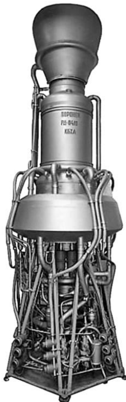
Рис. В.3. Общий вид ЯРД РД-0410 (тяга в пустоте 35,3 кН (3,6 тс); удельный импульс тяги 8 927 м/с (910 кг · с/кг); среднемассовая температура перед соплом 3 000 К; ресурс работы 3 600 с; число включений 10; масса с радиационной защитой и рамой крепления 2 000 кг; тепловая мощность реактора 196 МВт; габаритные размеры: длина — 3 500 мм, максимальный диаметр — 1 600 мм)
