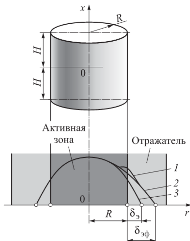
Рис. 11.3. АЗ реактора в виде цилиндра конечных размеров (с учетом влияния отражателя):
