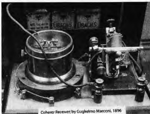
Рис. 49. Один из первых приемопередатчиков Маркони. Трубка спереди наверху – это когерер (Фото: Chetvorno / Wikimedia Commons, CC BY-SA 3.0)
