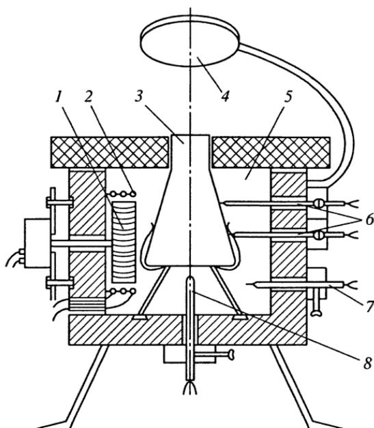
**Рис. 1.10.** Прибор для измерения стандартной температуры самовоспламенения СТС-2:
