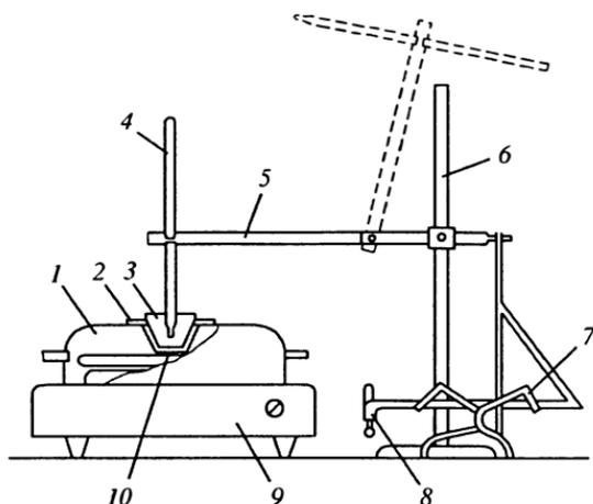
**Рис. 1.12.** Прибор открытого типа для измерения температуры вспышки:
