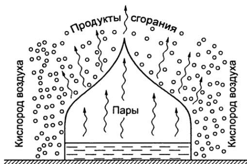
Рис. 1.1. Схема зоны горения паров жидкости — гомогенное горение
