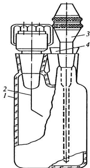
Рис. 1.17. Прибор для определения температурных пределов воспламенения (ТП):
