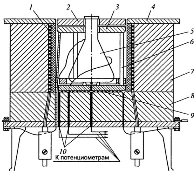
**Рис. 1.9.** Установка для определения стандартной температуры самовоспламенения: 1 — основной нагреватель; 2 — кольцо крышки; 3 — обогреватель горловины; 4 — крышка из огнеупорного материала; 5 — колба вместимостью  $200\text{ см}^3$ ; 6 — керамическая опора; 7 — поддерживающий цилиндр; 8 — электрический тигель печи; 9 — основной нагреватель; 10 — термопары
