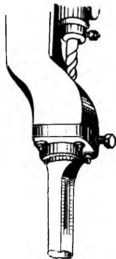
Рис. 177. Крепление полого долота и сверла в станке
