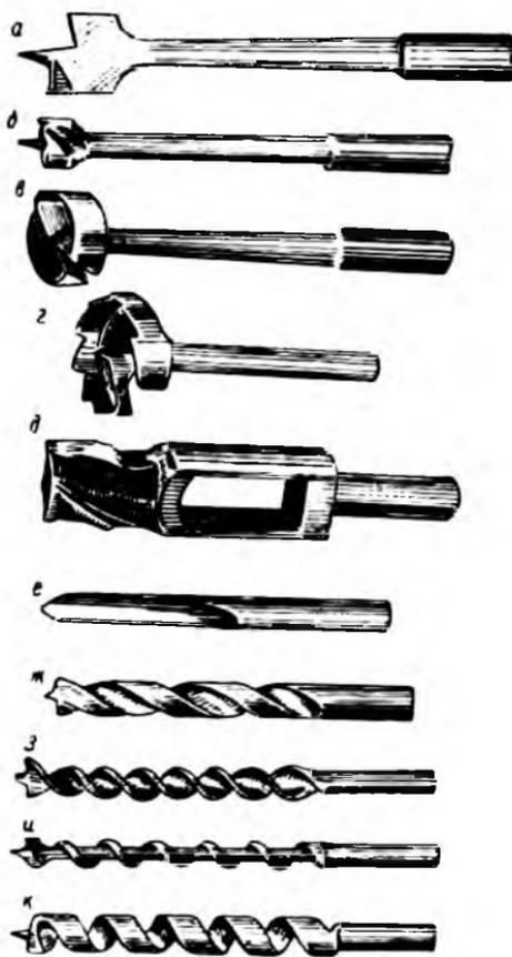
Рис. 150. Сверла для работы по дереву: а — простое центровое с плоской головкой; б — станочное центровое с цилиндрической головкой; в — с круглыми подрезателями; г — с зубчатыми подрезателями; д — полое цилиндрическое; е — ложечное; ж — спиральное; з — винтовое; и — шнековое; к — штопорное
