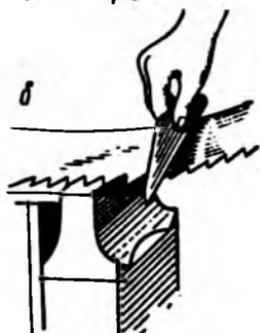
сильного натяжения в раме. Поперечное сечение полотна таких пил имеет вид, изображенный на рис. 19, б. Шаблон, приложенный к внутренней стороне изогнутой пилы, соприкасается своей гранью с серединой полотна, а по краям имеются просветы. При таком состоянии пилу необходимо выправить. Как правило, пилу необходимо вальцевать не меньше 3—4 раза за срок ее службы, чем восстанавливается правильное распределение напряжений в ее полотне. Без соблюдения этого условия пропадает смысл обработки полотен.
