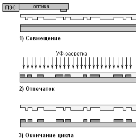
Рис. 7.23. Последовательность операций УФ наноимпринт-литографии
