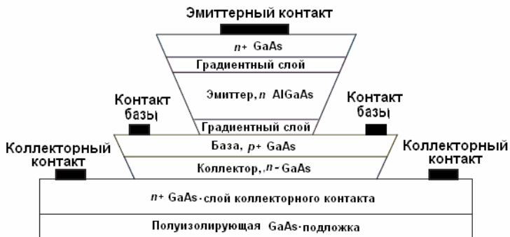
Рис 3.6. Типовая структура GaAs ГБТ
