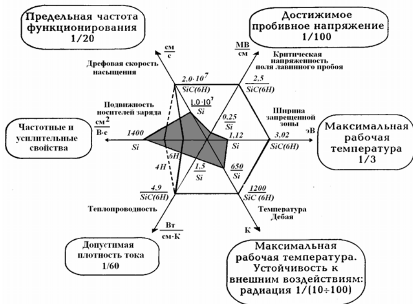
Рис. 5.1. Сравнение основных параметров Si и SiC (затемненная область – данные для кремния)
