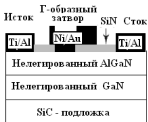
Рис. 3.14. Поперечный разрез структуры с Г-образным затвором
