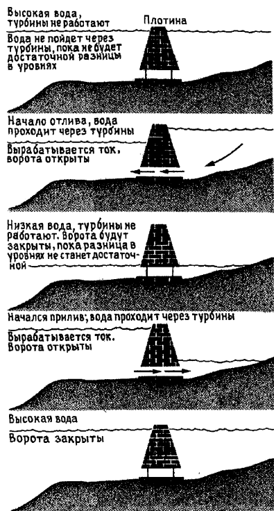
Рис. 5.1. Схема работы приливной электростанции
