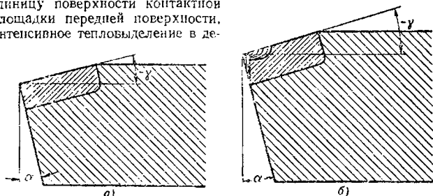
Фиг. 158. Геометрическая форма твердосплавного резца с отрицательным передним углом \gamma :
