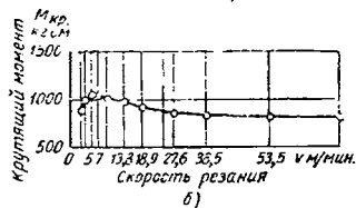
Фиг. 262. Влияние скорости резания на силы резания при сверлении:
