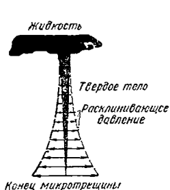
Фиг. 145. Расклинивающее действие жидкости в глубине трещины.
