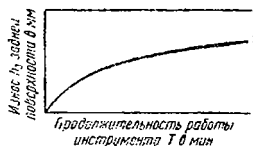
Фиг. 159. Характерная кривая износа инструментов, изнашивающихся только по задней поверхности.
