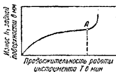
Фиг. 160. Характерная кривая износа инструментов, изнашивающихся одновременно по передней и по задней поверхностям.
