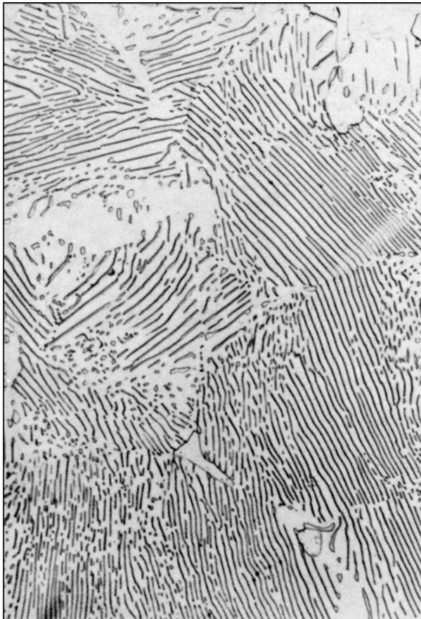
рис 2.3 Микроструктура заэвтектоидной стали с 1 % C: перлит пластинчатый. x1000
