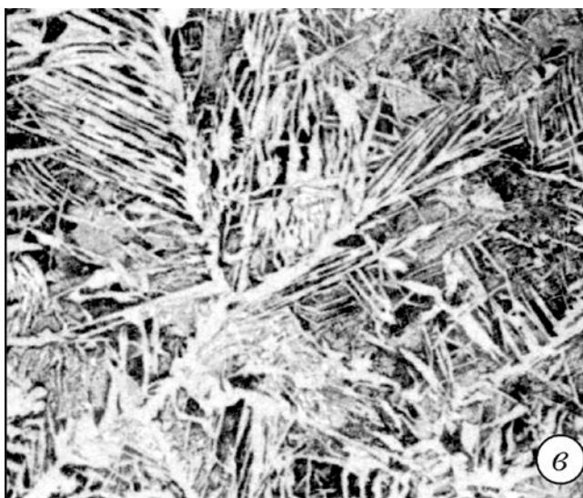
рис 2.7 Микроструктура стали: а, б – железоникелевая с 0,6 % С (100% мартенсита); в, г – углеродистая с 0,4 % С (видманштеттова структура); а – \times 500 ; б – \times 20000 ; в – \times 100 ; г – \times 5000
