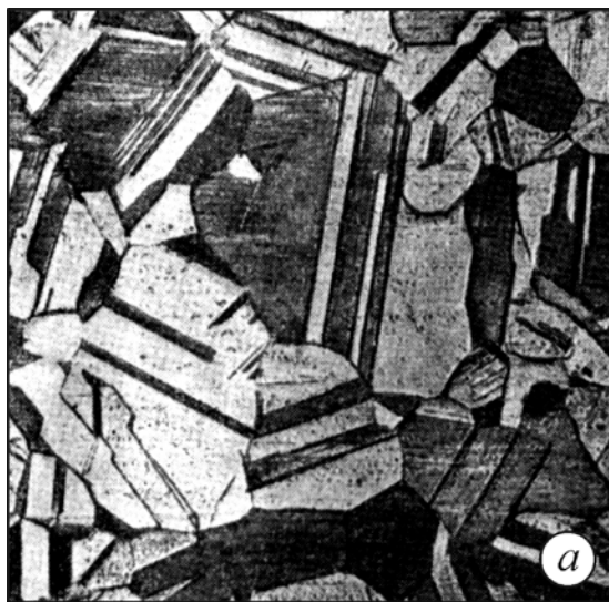
рис 2.12 Микроструктура \alpha - латуни x 250
