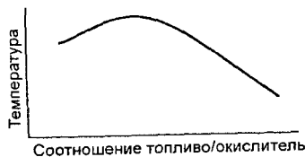
Рис. 4.1 Изменение температуры пламени в зависимости от соотношения топливо/окислитель
