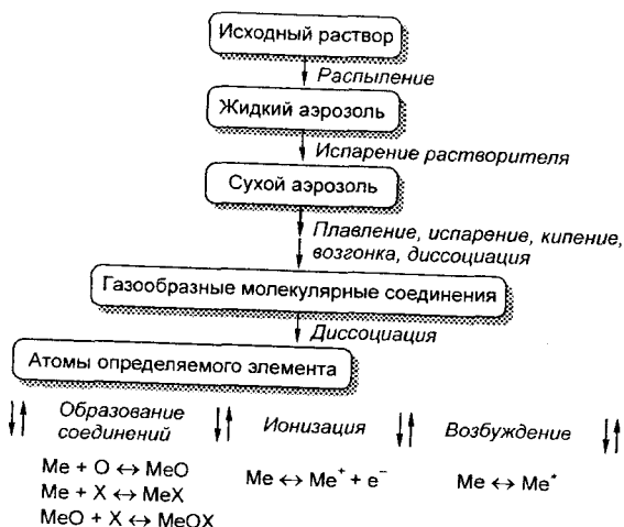
Рис. 4.7 Принципиальная схема основных физико-химических и термохимических процессов в пламени
