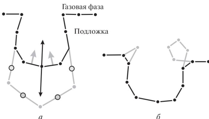
**Рис. 4.4.** Метод струны (*а*) и образование петли (*б*). Узел движется вдоль вектора, направленного по биссектрисе угла, образованного соседними линейными сегментами. Если расстояние между двумя узлами больше максимального размера сектора, то добавляется новый узел (*а*). Если какие-нибудь два узла находятся ближе друг другу чем минимальный размер сектора, то они объединяются в один, таким образом избегая образования петли. Избыточные узлы отбрасываются (*б*)
