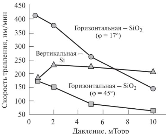
**Рис. 5.40.** Зависимости вертикальной и горизонтальной скорости травления  $\text{Si}$ ,  $\text{SiO}_2$  от давления для различных исходных углов маски
