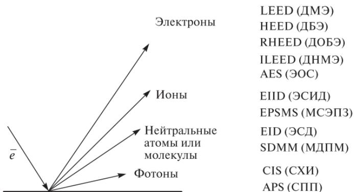
**Рис. 3.18.** Методы анализа поверхности, основанные на электронном облучении:
