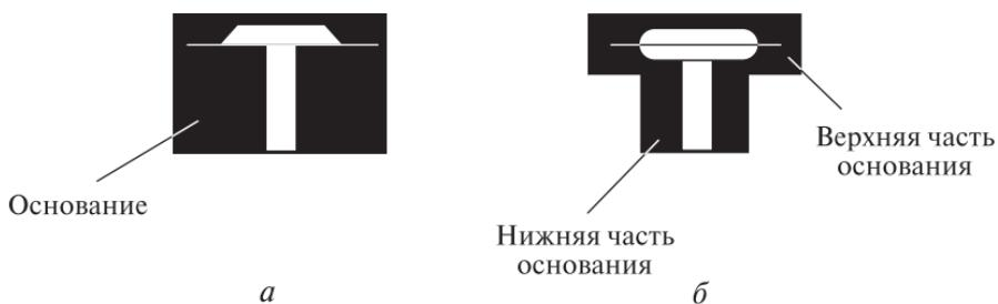
**Рис. 5.12.** Схема ЧЭ интегральных преобразователей давления:
