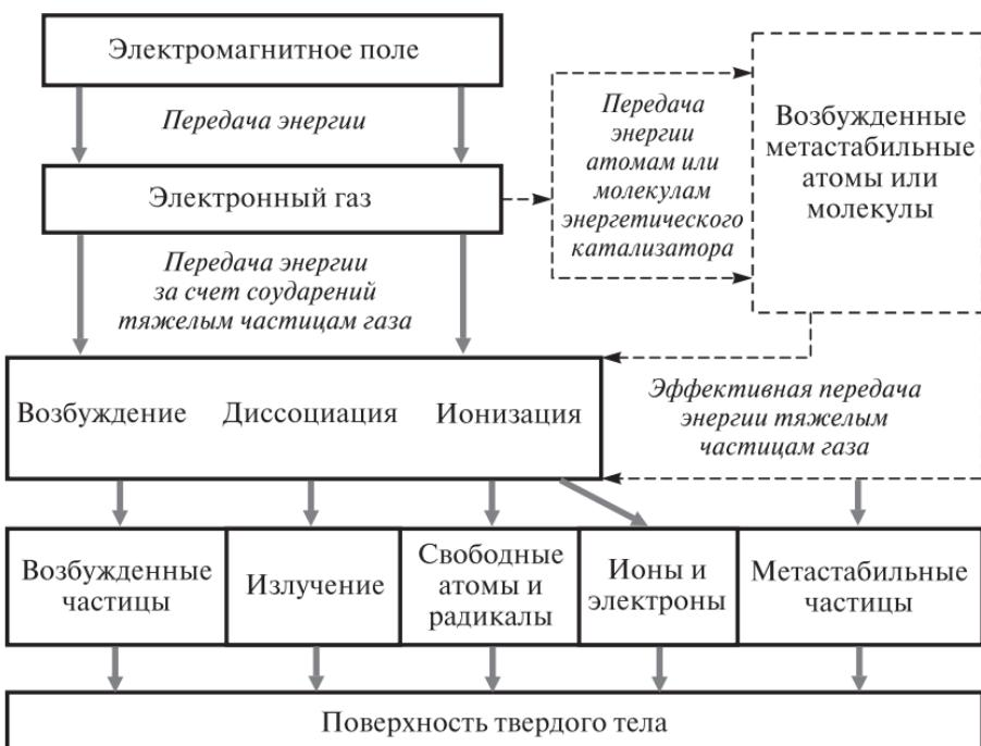
**Рис. 1.5.** Схема передачи энергии электромагнитного поля в низкотемпературной газоразрядной плазме
