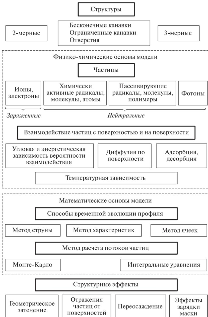
**Рис. 4.3.** Схема модели формирования профилей травления [41]
