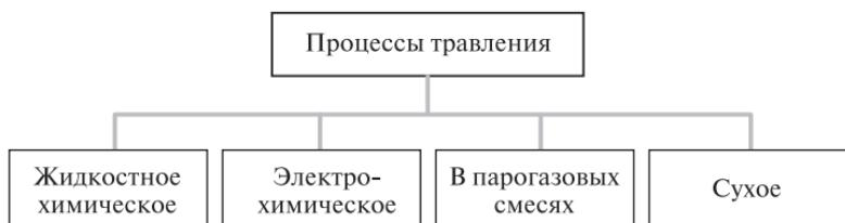
**Рис. 1.1.** Обобщенная классификация процессов травления
