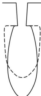
**Рис. 4.15.** Сравнение экспериментально полученного (сплошная линия) и смоделированного (штриховая линия) профилей отверстия  $0,35 \text{ мкм}$  при давлении 75 мТорр и смещении  $-120 \text{ В}$
