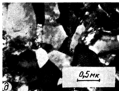
Рис. 84. Структура при нагреве деформированного крупнопластинчатого перлита (фольга):
