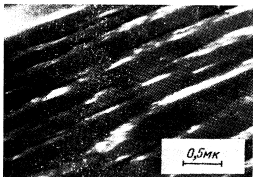
Рис. 61. Микроструктура холоднодеформированной стали 70, темнопольное изображение в свете рефлекса (001) \sigma .
