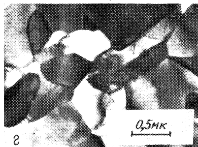
Рис. 85. Структура при нагреве деформированного тонкопластинчатого перлита (фольга):
