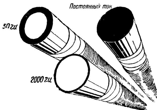
Фиг. 1. Распределение тока в проводе при поверхностном эффекте.
