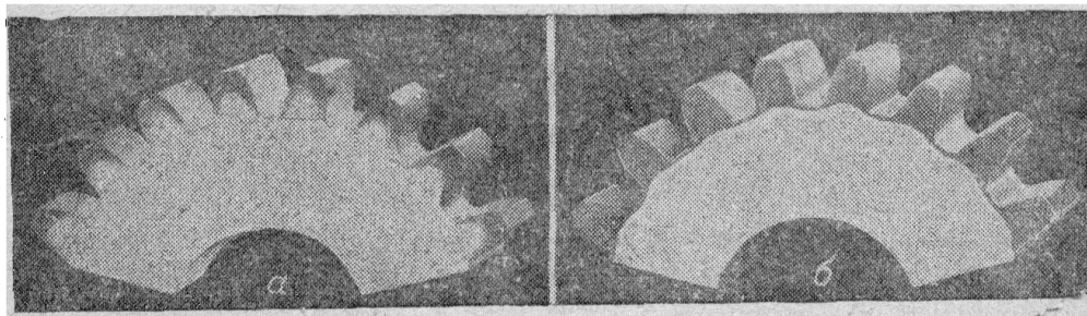
Фиг. 82. Макрошлифы шестерен, закаленных на разных частотах а—250 000 гц; t_k = 1,9 сек., P = 172 кат; б—250 000 гц; t_k = 3 сек.
