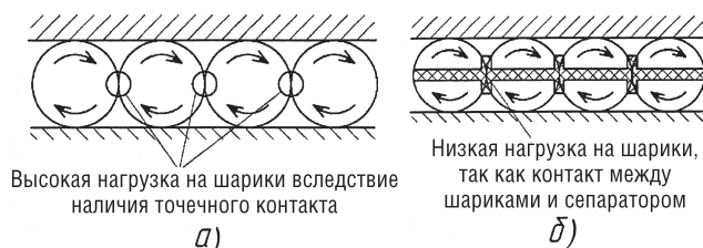
Рис. 5.28. Особенности контакта между шариками в опоре качения: а — без сепаратора; б — с сепаратором
