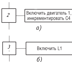
Рис. 8.5. Примеры этапов процесса управления: а — неактивного; б — активного
