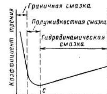
Рис. 122. Схема перехода из одного режима трения в другой
