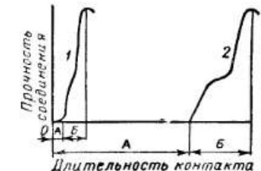
Рис. 101. Характер изменения прочности соединения металлов в условиях быстрого (1) и медленного (2) образования физического контакта:
