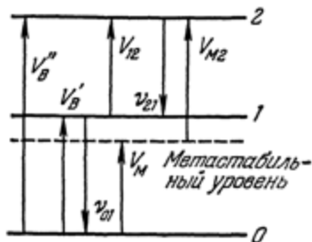
Рис. 62. Схема ступенчатого возбуждения уровней.
