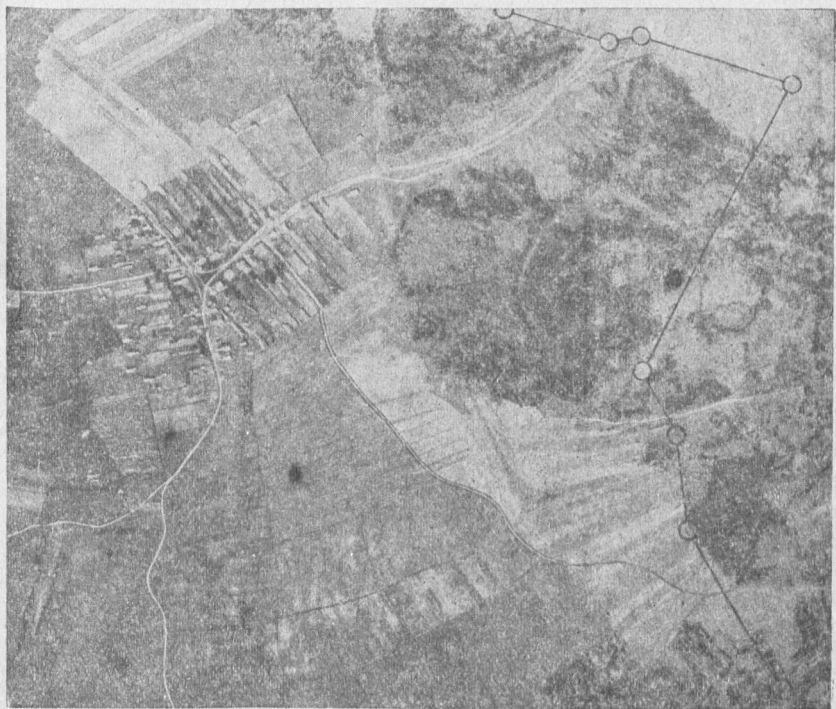
Рис. 32. Контактный отпечаток с негатива 18 \times 18 см, снятого с высоты около 2 100 метров в масштабе около 1:10\,000 . В первой части показаны: кружками—поворотные точки части окружной межи, прямыми линиями — стороны многоугольника окружной межи, получившиеся от соединения центров кружков. Поворотные точки могут быть опознаны на местности по мелким признакам (начиная снизу снимка): конец полосы кустарника, угол леса, угол пашни, вдающейся в лес, и дорога, песчаная поляна — бугор среди кустарника, край луга и дорога, угол пашни, дорога, опушка леса и т. д. Возможно и обратное: наметка поворотных точек на местность и перенесение их на планшет-фотоплан после их привязки. По таким мелким признакам могут быть проектированы по планшету-фотоплану или по контактному отпечаткам внутренние нарезки участков и угодий — в соответствии с планом хозяйства, а затем и они могут быть перенесены на местность. Возможно и обратное: наметка нарезок на местности и перенесение их на планшет-фотоплан.
