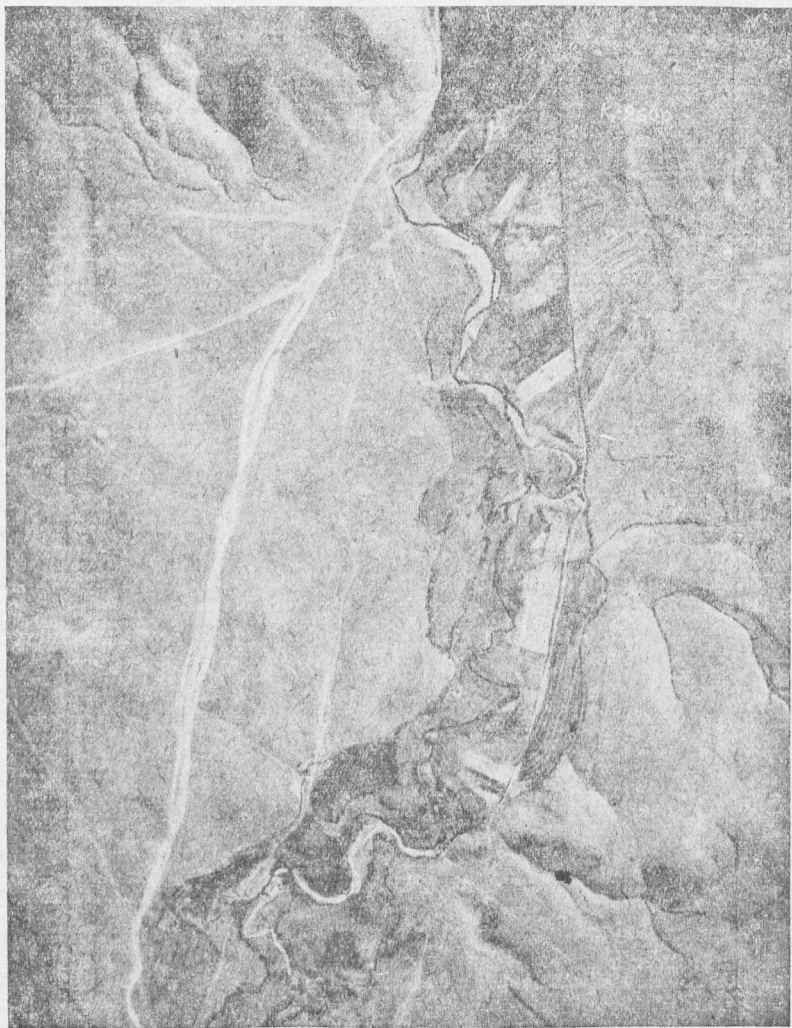
Рис. 25. Уменьшенный контактный отпечаток с негатива 18 \times 24 см, снятого с высоты около 2400 метров в масштабе около 1 : 12\,000 . Местность прорезана рекою, текущей в глубокой промоине; слева большая дорога; во многих направлениях видны дорожки и тропы.
