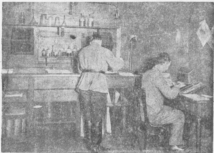
Рис. 20. Часть темной стационарной фотолаборатории. Вдоль стены моечный стол; у него фотолаборант; на верхних полках стола разного рода химикалии; внизу стола — полки с ваннами и необходимою посудой; видны трубы водопровода и кран. Вправо фотолаборант, работающий на автоматическом копировальном станке. Работа происходит при слабом освещении красным светом фонарей, прилаженных к вертикальной стенке моечного стола; во время фотографирования был пущен дневной свет.
