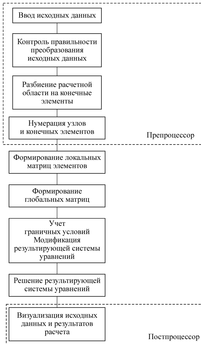
Рис. П5. Принципиальная блок-схема программного обеспечения для реализации МКЭ
