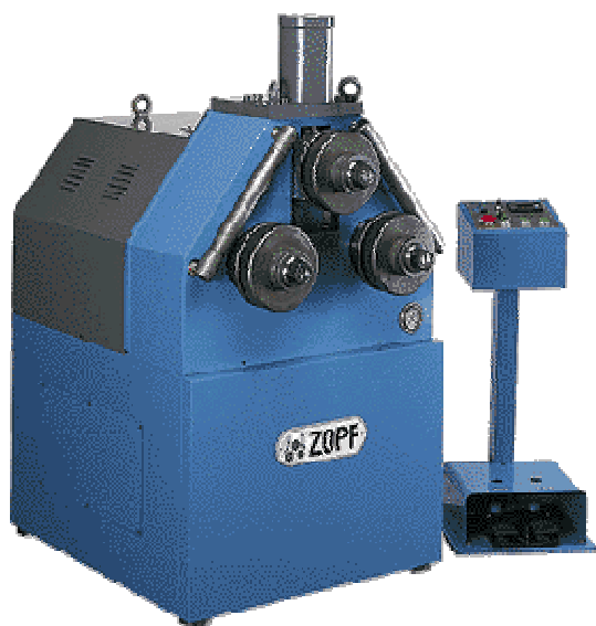
Рис. 4.10. Общий вид листогибочной машины, реализующей схему гибка-прокатка
