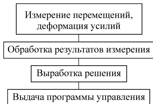
Рис. 5.4. Обобщенный алгоритм системы автоуправления для обтяжного оборудования
