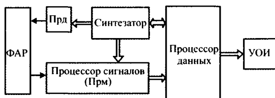
Рис. 1.4. Построение современной импульсной РЛС
