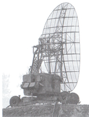
Рис.12.1. Радиолокационный наземный высотомер РВ-19
