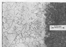
Рис. 104. Науглероживание поверхностного слоя образца нержавеющей стали типа 304.
