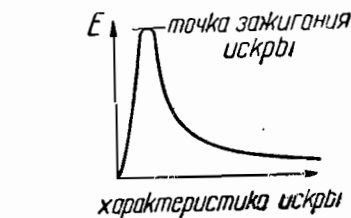
Рис. 150. Зависимость тока от напряжения в газе. (По Биндеру).
