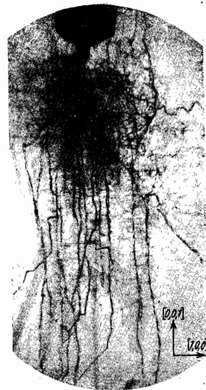
Рис. 354. Фотография дендрита в каменной соли при постоянном напряжении при 450^{\circ}\text{C} .
