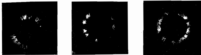
Рис. 324. Развитие краевых разрядов на стекле в трансформаторном масле. Ударное напряжение. Слева направо: 20 kV, 26 kV и 32,5 kV. (По Вулу и Инге).
