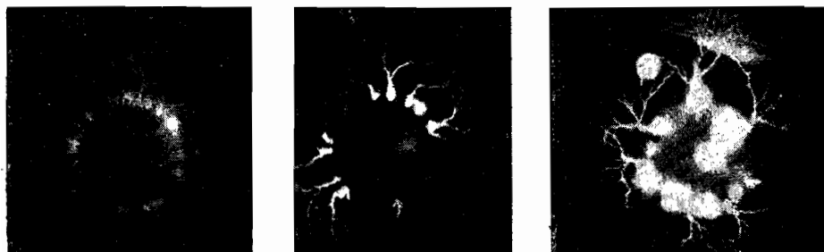
Рис. 325. Развитие краевых разрядов на стекле в анилине. Ударное напряжение. Слева направо: 32,5 kV, 37,5 kV и 40 kV. (По Вулу и Инге).
