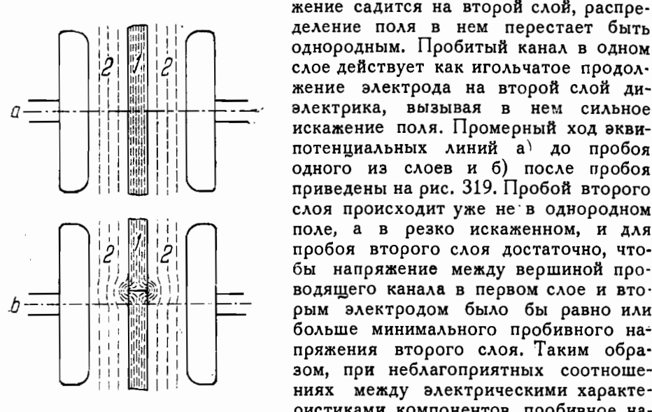
Рис. 319. Искажение поля, сопровождающее пробой одного из слоев слоистого диэлектрика. (По Марксу).
