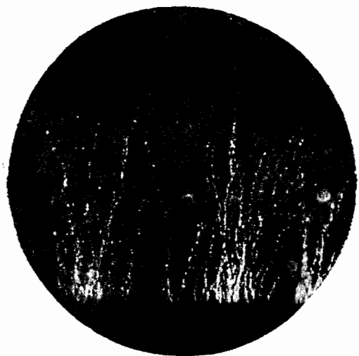
Рис. 342. Фотография неполного пробоя стекла. Длительность импульса 10^{-8} сек.
