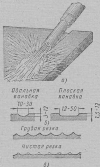
Фиг. 16. Схема процесса поверхностной кислородной резки: а — схема процесса; б — форма канавок; в — профиль поверхности
