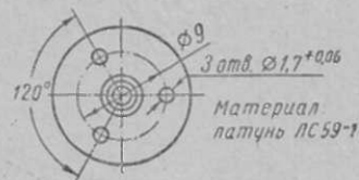
Фиг. 13. Внутренние сопла кероси- норезов К-48 и К-51
