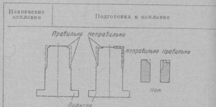
Фиг. 42. Подготовка фаски под наплавку твердым сплавом
