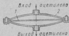
Фиг. 5. Фильтр для механической очистки ацетилена: 1 — матерчатый фильтр; 2 — корпус
