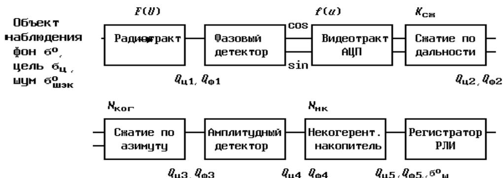
Рис. 3.1. Сечения радиолокационного тракта
