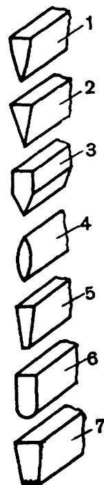
Рис 165 Сечения различных видов штихелей: 1 — шпичштихель 2 — мессерштихель 3 — фасетштихель, 4 — юстирштихель, 5 — флахштихель 6 — болштихель 7 — фаден штихель
