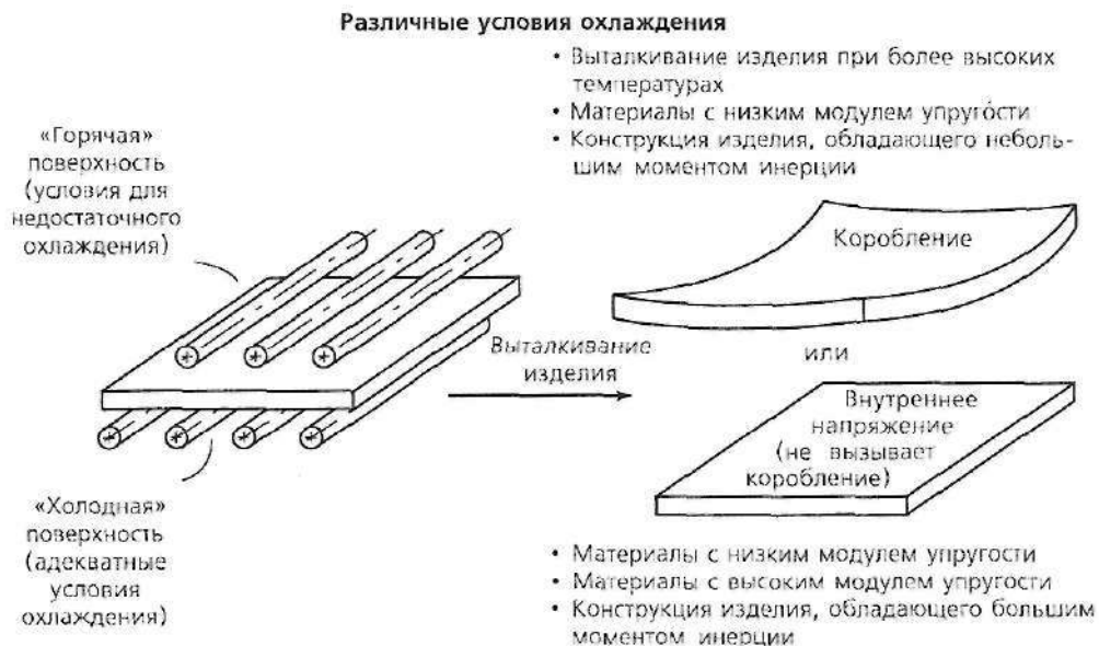
Рис. 2.68. Коробление или внутренние напряжения могут быть вызваны различным по интенсивности охлаждением, которое приводит к усадке по толщине изделия. Более горячие поверхности имеют тенденцию к большей усадке после того, как изделие выталкивается из формы
