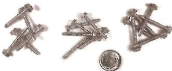
Рис. 6.47. Существует большое количество создающих резьбу винтов. Показаны винты #6 с шестигранными головками с шайбами: слева — создающий резьбу винт типа BT ; в центре — пинг, формирующий винт типа HiLo ®; справа — самонарезающий винт типа T
