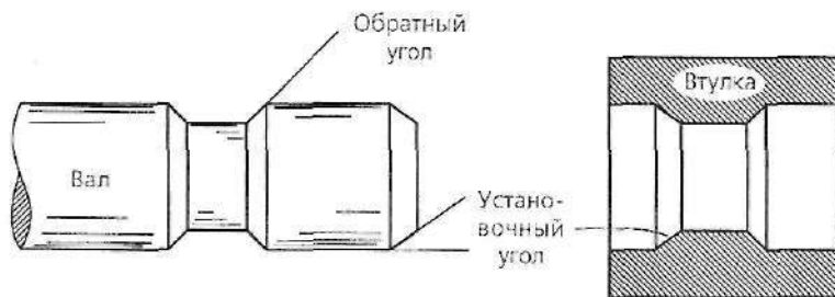
Рис. 6.11. Установочные и обратные углы замкового соединения влияют на введение одной детали в другую и разделение деталей
