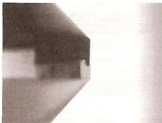
Рис. 6.109. Поперечное сечение сварного ступенчатого соединения, полученного с помощью ультразвуковой сварки. Выступы улучшают центрирование деталей и маскируют наплыв материала
