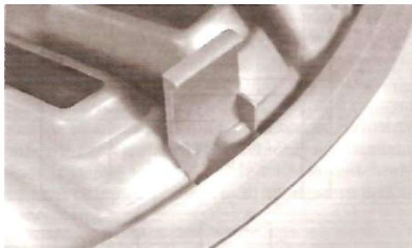
Рис. 6.17. Колпак автомобильного колеса, изготовленный литьем под давлением, включает в себя набор разъемных крючков
