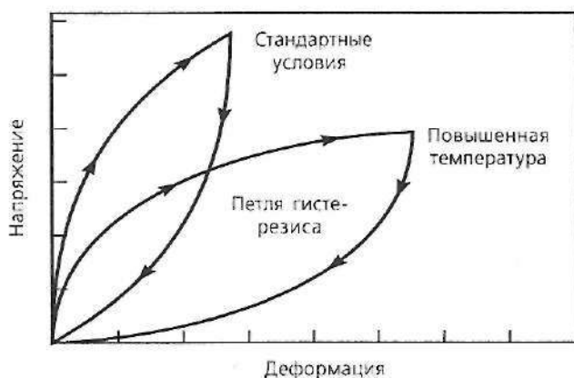
Рис. 4.76. Площадь петли гистерезиса определяет диссипацию энергии при вязком трении
