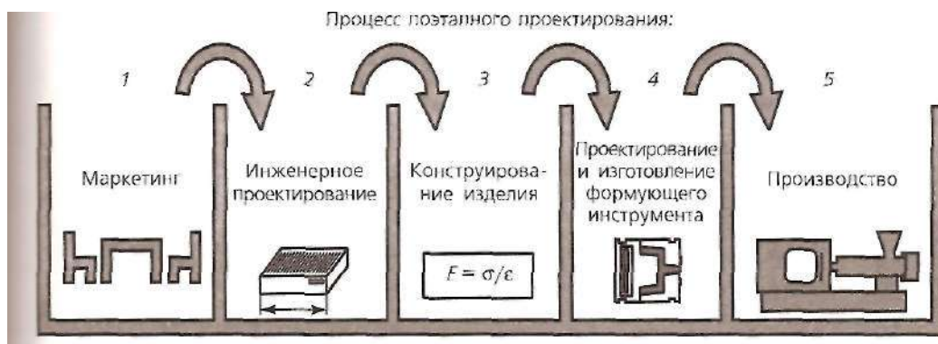
Рис. 3.1. Проектирование изделия с помощью «последовательной технологической подготовки производства»
