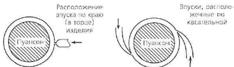
Рис. 2.49. Литниковые системы с расположением впуска по касательной могут быть использованы вместо обычной системы с расположением впускного литника по краю изделия в целях изменения характера заполнения формующей полости и улучшения прочностных характеристик области спая
