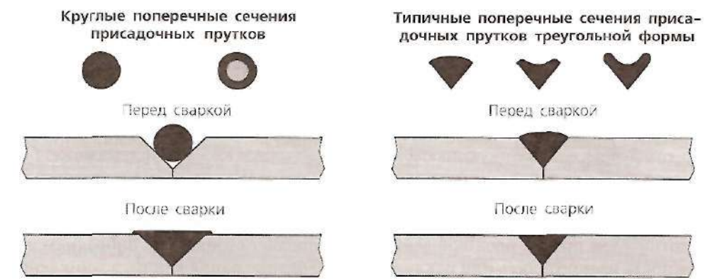
Рис. 6.127. Типичные соединения и конфигурации присадочных прутков при сварке деталей из термопластов нагретым газом
