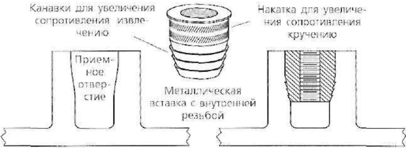
Рис. 6.87. Оборудование для ультразвуковой сварки может быть использовано для введения вставок в бобышки
