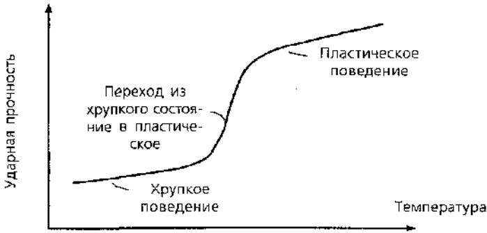
Рис. 338. Ударная прочность у большинства полимерных материалов возрастает с увеличением температуры
