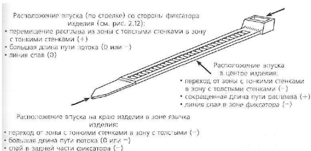
Рис. 2.17. Конструкторы должны определить наиболее предпочтительные места расположения впусков и сравнить относительные преимущества и недостатки каждого варианта литниковой системы
