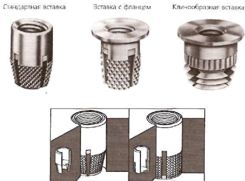
Рис. 6.92. Возможны различные конфигурации расширяющихся вставок. Во вставках используется специальная шайба, которая опускается и расширяет снабженную накаткой часть вставки (с разрешения Heli-coil Division, Emhart Fastening Group )
