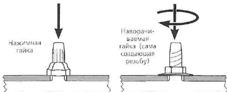
Рис. 6.73. Нажимная гайка напрессовывается на отлитый стержень, а создающие резьбу наворачиваемые крепежные части применяют, когда требуется контролировать давление затяжки
