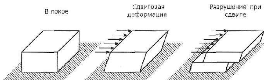
Рис. 4.67. Разрушение при скручивании, при превышении сдвиговой прочности материала
