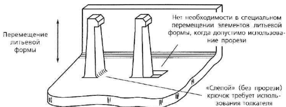
Рис. 6.31. Геометрия детали может быть изменена с учетом необходимости извлечения отливки. Прорези в стенках позволяют отказаться от использования специальных перемещений элементов литейной формы
