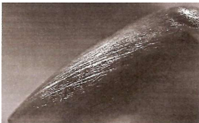
Рис. 3.28. На снимке показано образование трещин в изделии из акрила
