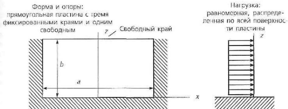
Рис. 4.57. Прямоугольная пластина с равномерно распределенной нагрузкой по всей поверхности, имеет три фиксированных края и один свободный
