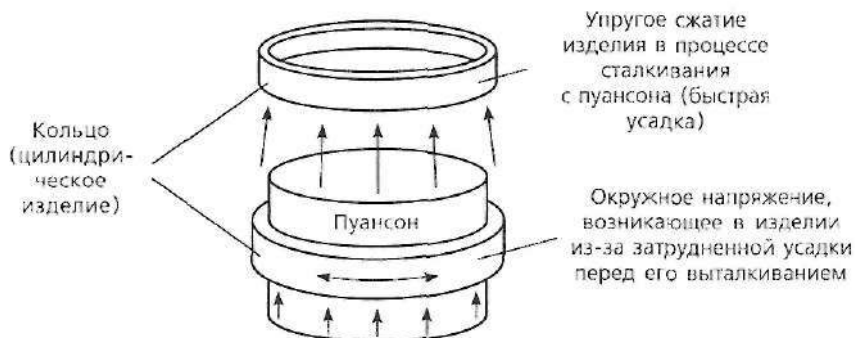
Рис. 2.101. Усадка изделия из пластмассы во время охлаждения в форме затруднена, она «ограничивается» пуансоном. Изделие испытывает упругое сжатие сразу после выталкивания; его размеры будут изменяться вследствие релаксации напряжений
