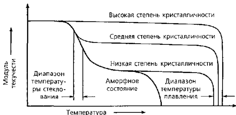
Рис. 3.45. Температурная зависимость модуля для аморфных и частично кристаллических полимеров
