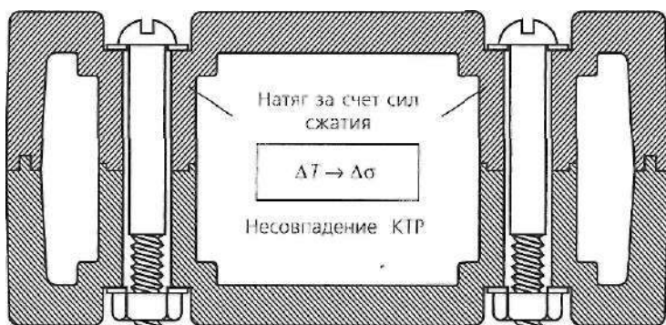
Рис. 6.44. КЛТР у стальных крепежных деталей меньше, чем у большинства полимерных материалов. Несовпадение КЛТР будет приводить к изменению затяжки за счет сжатия, вызванного изменением температуры окружающей среды
