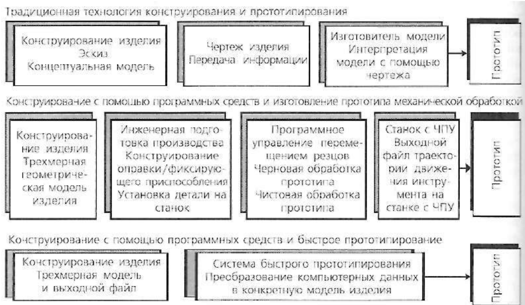
Рис. 5.5 Сравнение технологий: традиционный метод механической обработки и быстрое Прототипирование
