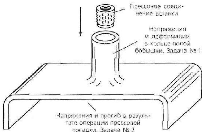
Рис. 4.4. Изделия более сложной геометрической формы для проведения анализа могут быть разбиты на несколько фигур стандартной формы
