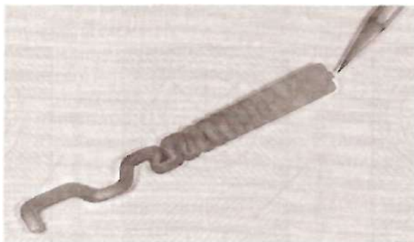
Рис. 2.35. Когда наблюдается эффект струйного заполнения, изделие, как правило, имеет дефекты поверхности, отличается плохим внешним видом. Струйное заполнение может также приводить к ухудшению механических свойств изделия
