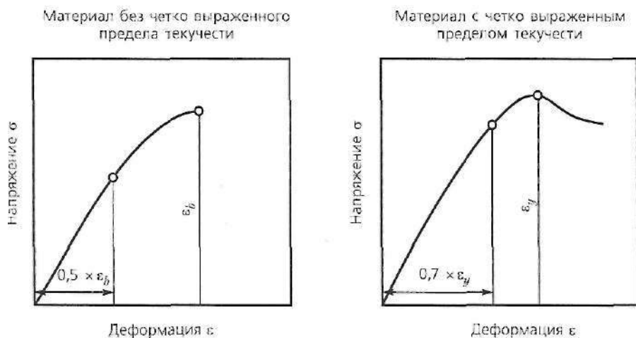
Рис. 6.36. Максимально допустимые значения деформации изменяются в зависимости от типа материала
