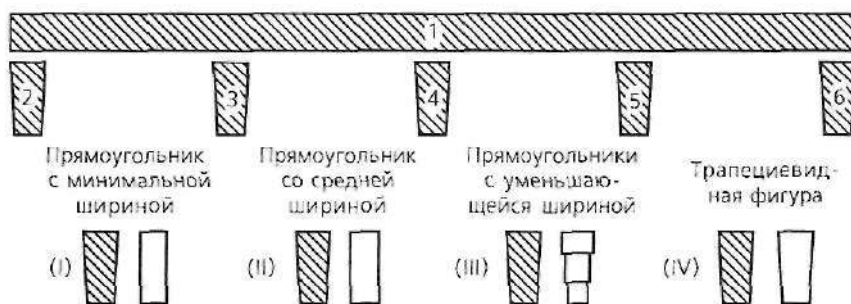
Рис. 4.35. Поперечное сечение балки сложной формы представлено в виде набора шести отдельных фигур для расчета момента инерции.
