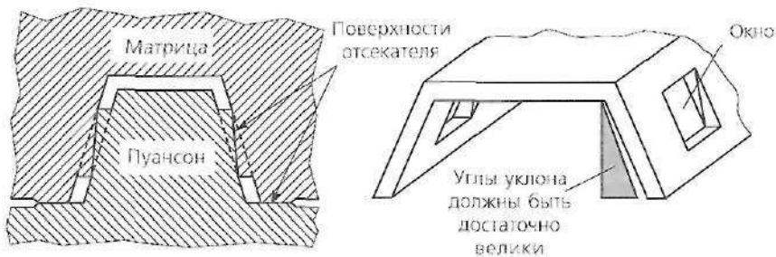
Рис. 2.96. Отверстие в боковой стенке формируется с помощью отсекателей, а выталкивание изделия из формы происходит после ее размыкания по плоскости разреза матрицы/формы
