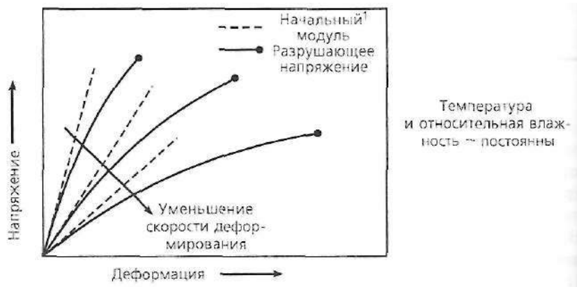
Рис. 4.15. Характеристики полимерных материалов, полученные из кривых напряжение-деформация, зависят от скорости деформирования, температуры и относительной влажности
