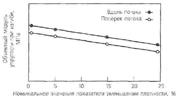
Рис. 2.112. Механические свойства вспененных пористых термопластических структур, армированных волокнами, зависят как от уменьшения плотности, так и от ориентации волокон
