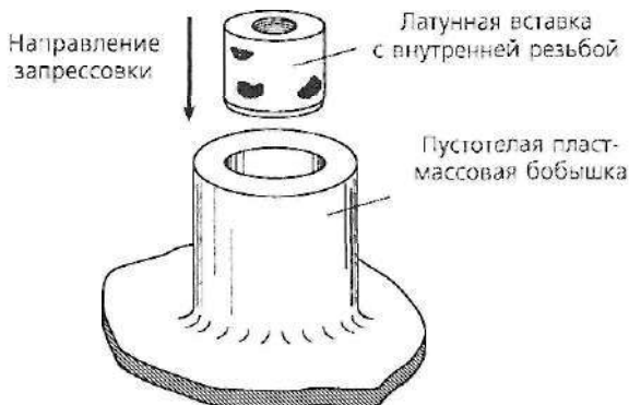
Рис. 6.85. Для фиксации вставки используются различные методы. В простейшем случае вставка просто запрессовывается в отверстие меньшего, чем ее диаметр, размера
