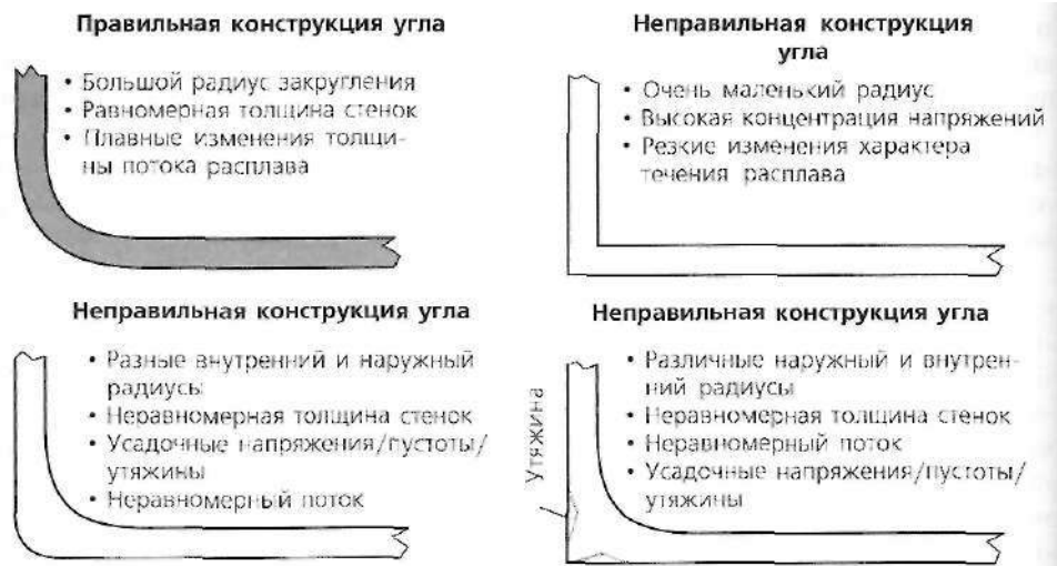
Рис. 2.14. Идеальные закругления должны быть одинаковыми как на внутренних, так и на наружных поверхностях и углах изделия. Равномерная толщина стенок может поддерживаться за счет выбора наружного радиуса, равным внутреннему, с учетом толщины стенки. Большая толщина стенок в углах будет приводить к образованию утяжин, пустот, усадочных напряжений и потенциальной возможности возникновения турбулентных завихрений при течении расплава
