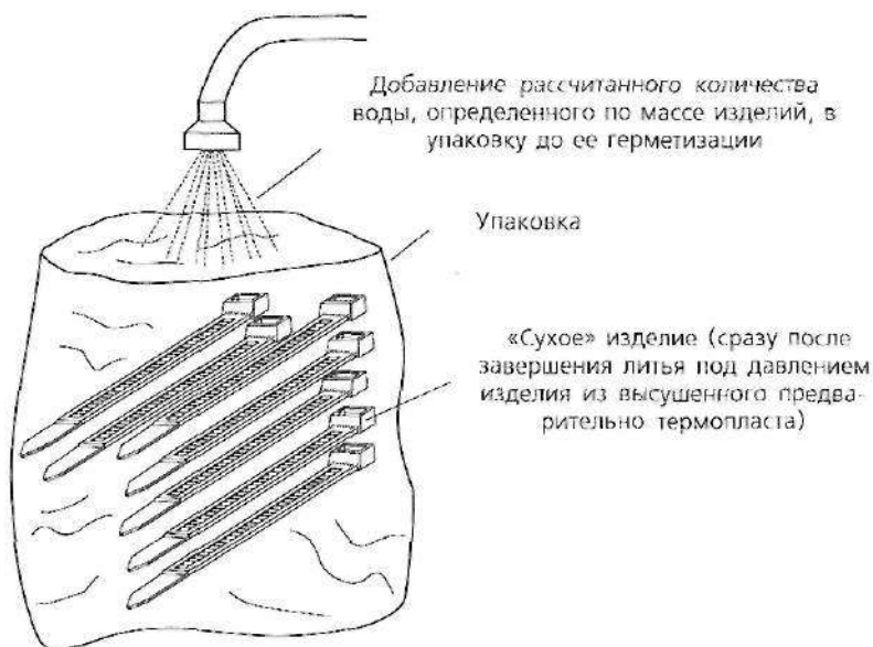
Рис. 2.65. Рассчитанное количество воды может быть «добавлено» в сухое изделие сразу после литья под давлением (из высушенного предварительно термопласта), чтобы обеспечить в нем повторную абсорбцию влаги
