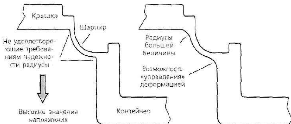
Рис. 6.40. Классический отклоняющийся шарнир часто используется вместе с крючками для закрепления крышек на корпусе контейнера, имеющего форму ракушки
