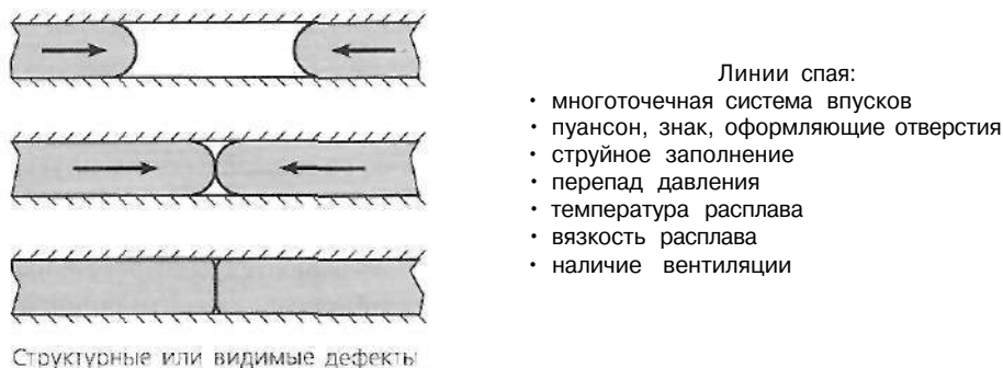
Рис. 2.37. Типичная схема последовательности формирования линии спая. Линии спая возникают, когда фронт расплава разделяется и затем снова соединяется в более удаленном от места впуска участке. Линия спая возникает также, когда используется система с многоточечными впусками или при обходе расплавом пуансонов, знаков и при возникновении эффекта струйного заполнения формирующей полости
