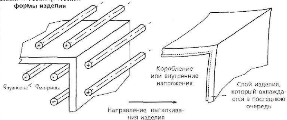
Рис. 2.69. Изменение условий охлаждения расплава по толщине изделия может быть вызвано различными скоростями охлаждения слоев, прилегающих к матрице и к пуансону. Обычно охладить пуансоны труднее, чем матрицы. Более горячая сторона изделия будет испытывать большую усадку после выталкивания изделия, что приводит к возникновению внутренних напряжений, короблению изделия
