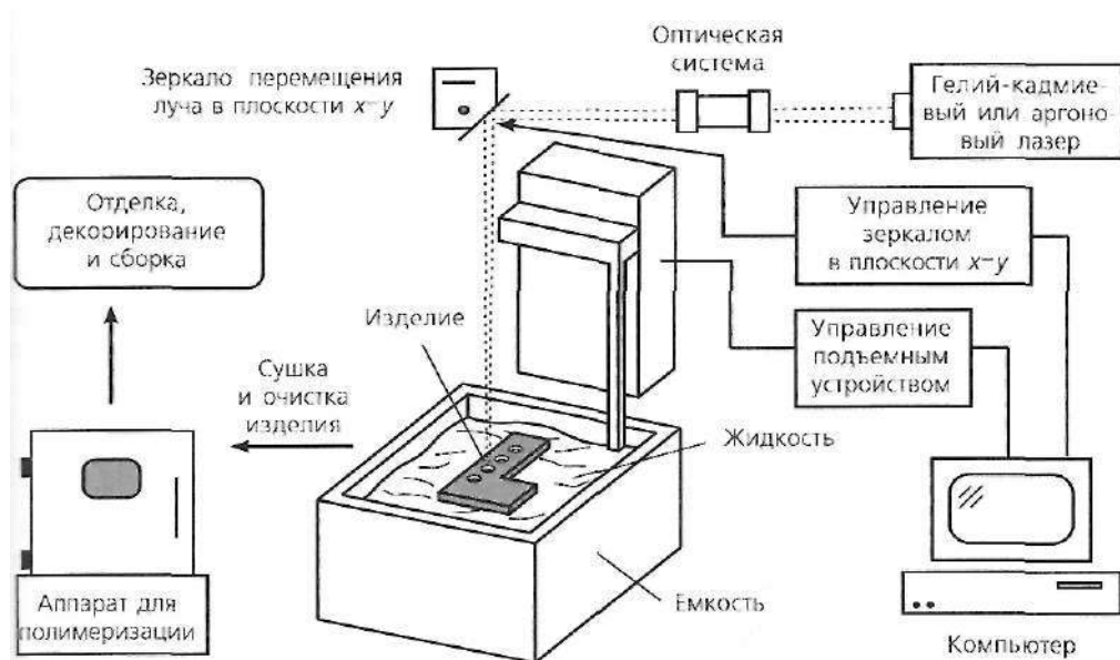
Рис. 5.10. Схема прототипирования методом фотополимеризации
