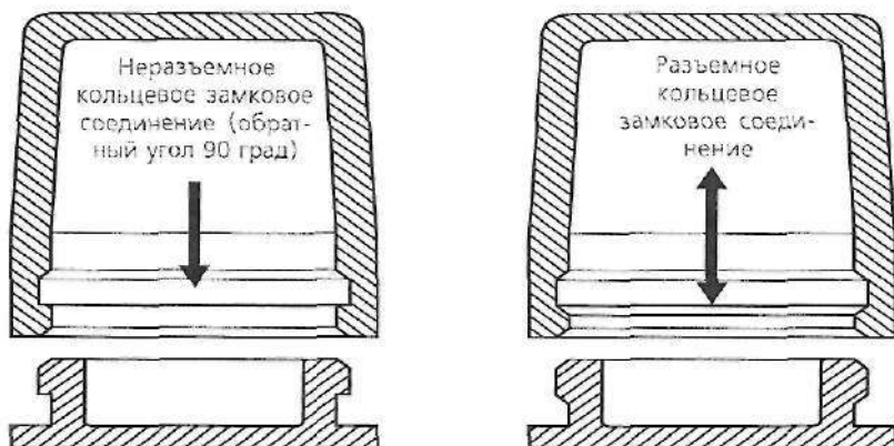
Рис. 6.10. Сборочные узлы с замковыми соединениями могут быть сконструированы как разъемными, так и неразъемными
