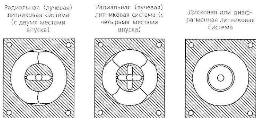
Рис. 2.2. Варианты литниковых систем для изделия типа обода колеса; радиальные (лучевые) и дисковые литниковые системы с местами впуска на внутренней поверхности отливки; дисковая литниковая система гарантирует равномерное заполнение и уплотнение расплава без образования линий спая
