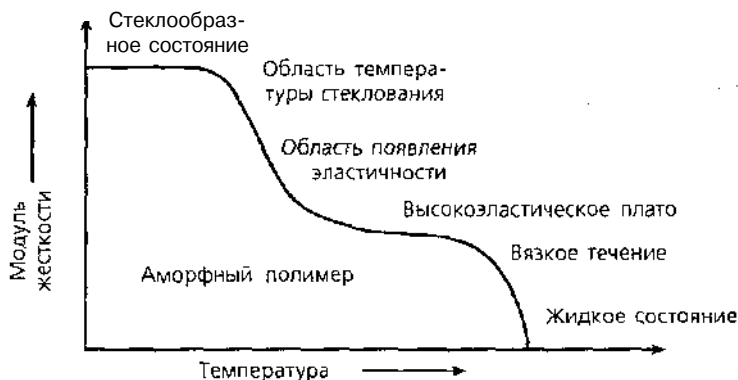
Рис. 3.44. Зависимость модуля от температуры для аморфного полимера
