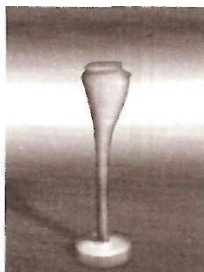
Рис. 5.3. Модели пластмассовых изделий, изготовленные из цилиндрической заготовки механической обработкой: слева — детали узла привода; справа — модель протеза
