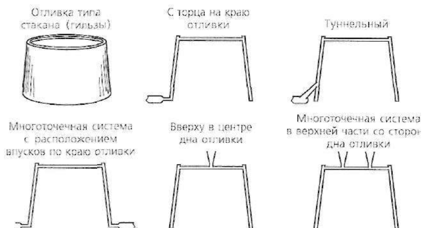
Рис. 2.1. Стандартные варианты расположения впускных литников для изделия типа стакана (гильзы). К возможным вариантам относятся впуски на торцах, туннельные литники и точечные впускные литники со стороны дна отливки
