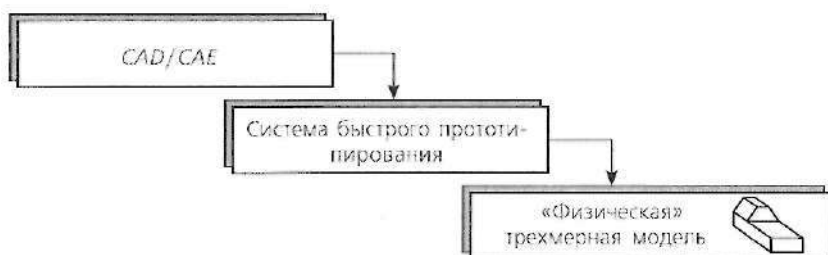
Рис. 5.4. Последовательность технологии быстрого прототипирования
