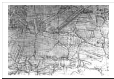
Рис. 25. Структура сплава, содержащего 95 % Ag
