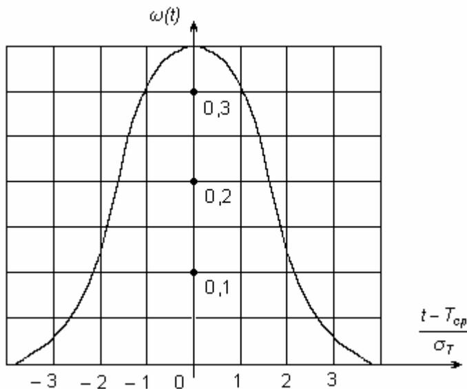
Рис. 2.10. Плотность распределения наработки до отказа для нормального распределения.
