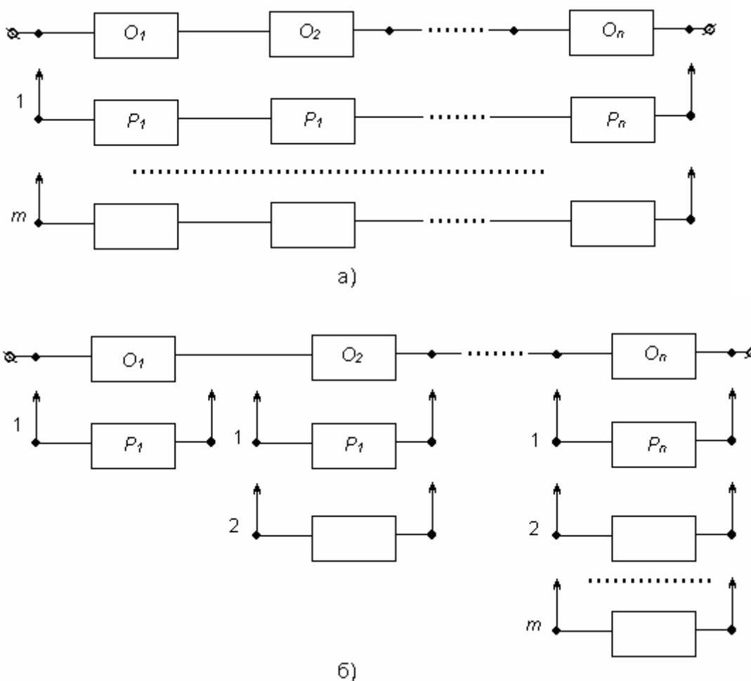
Рис. 6.4. Резервирование замещением: а – общее; б – раздельное.
