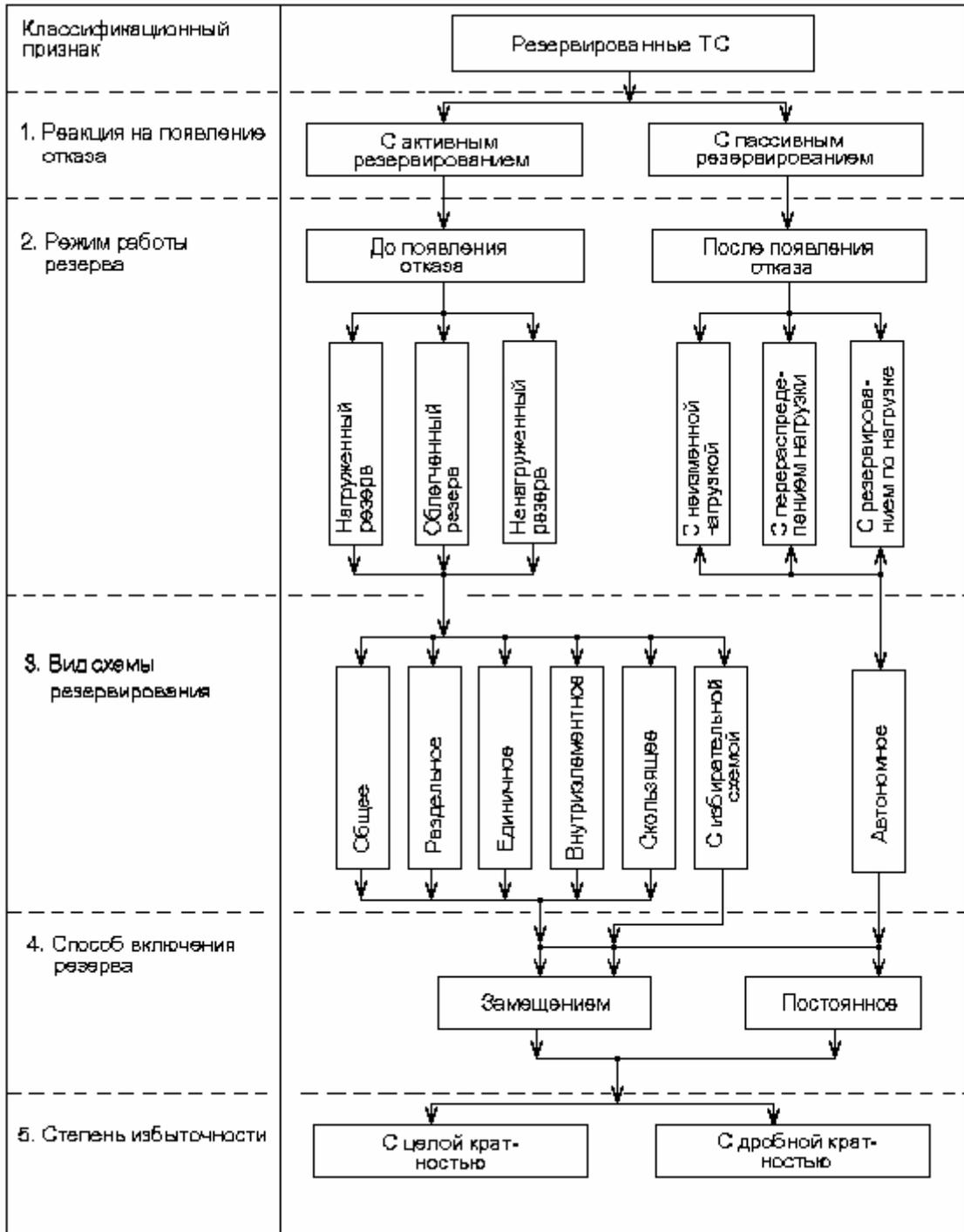
Таблица 6.1. Классификация резервированных ТС.
