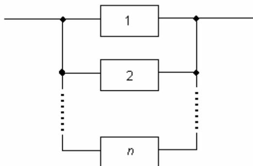
Рис. 4.11. Параллельное нагруженное соединение.
