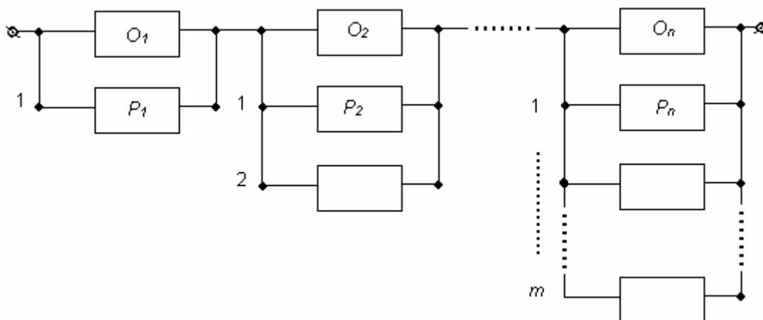
Рис. 6.3 Раздельное резервирование с постоянно включенным резервом.
