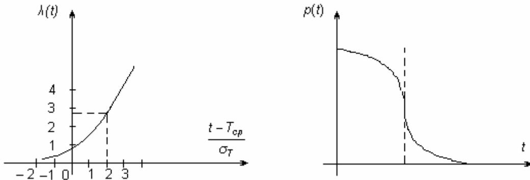
Рис. 2.12. Графики функции надежности и интенсивности отказов при усеченном нормальном законе распределения.
