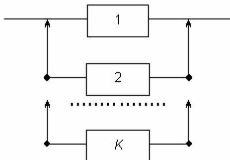
Рис. 4.12. Параллельное ненагруженное соединение.
