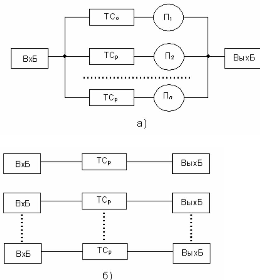
Рис. 6.1. Структуры общего резервирования:
