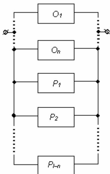
Рис. 6.6. Дробное резервирование.
