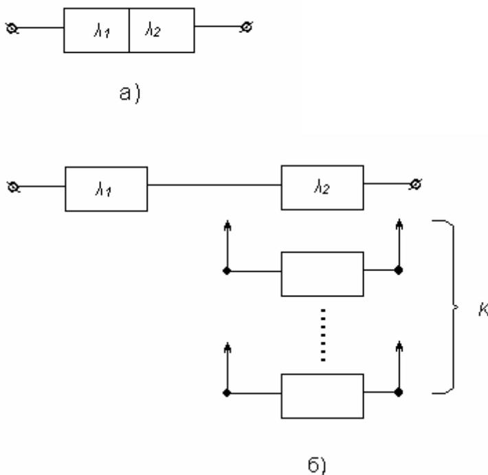
Рис. 6.8. ТС, защищенные самокорректирующимся кодом (приближенный расчет надежности).
