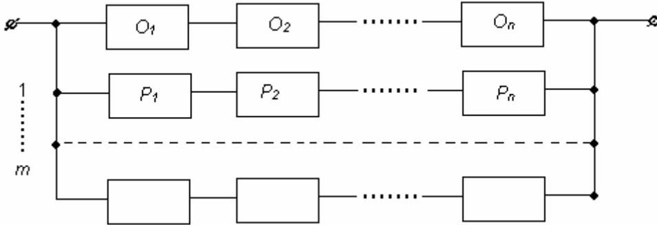
Рис.6.2. Общее резервирование с постоянно включенным резервом.
