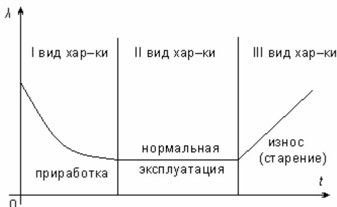
Рис. 2.1. Зависимость интенсивности отказов от времени.
