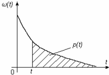
Рис. 1.2. Плотность распределения наработки до отказа.
