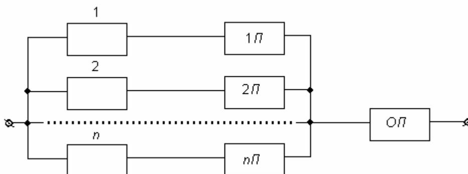
Рис. 6.5. Расчетно-логическая схема резервированной группы с переключением.
