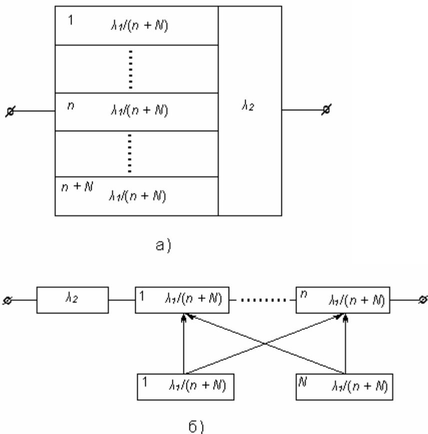
Рис. 6.9. ТС, защищенные самокорректирующимся кодом (уточнена расчет надежности).
