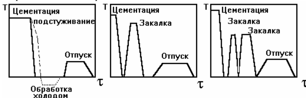
Рис. 49. Режимы термической обработки цементированных деталей.
