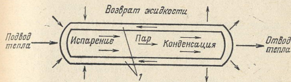
Рис. 3.17. Коллектор, работающий на принципе тепловой трубы.
