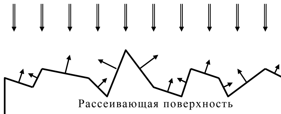
Рис. 6.2. Модель рассеяния на шероховатой поверхности
