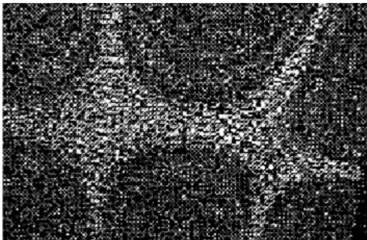
Рис. 6.36. Характерная картина спекл-интерферограммы.
